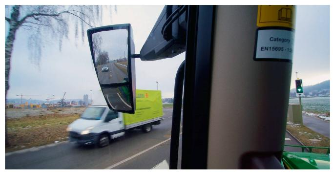
Motorfahrzeuge, die sichthemmende Ladung oder Anhänger mitführen, müssen links und rechts aussen je einen Rückspiegel tragen, der dem Fahrer erlaubt, die Fahrbahn seitlich neben den Ladungen oder Anhängern und nach hinten mindestens 100 m weit zu überblicken. Bild: R.Engeler
