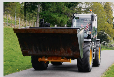
Das neue Topmodell unter den Teleskopladern von JCB für die Landwirtschaft: Der «542-70 Agri Pro» weist eine Höchstgeschwindigkeit von 50 km/h auf.
