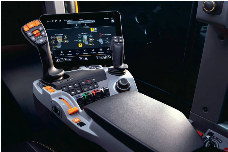
Viele Befehle und auch Funktionstasten auf dem Joystick sind auf dem 12 Zoll grossen Monitor individuell programmierbar. Bild: JCB
