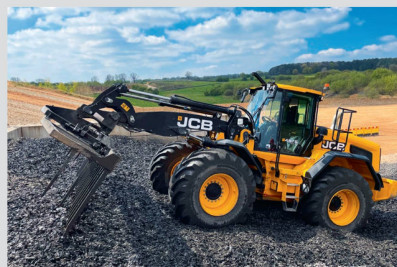
Mit dem Modell «457S» hat JCB ein neues Flaggschiff unter den Radladern im Angebot. Mit einer Nutzlast von 6 t und einer Hubhöhe von 4,3 m (4,8 m in der Version «High Lift») weist die Maschine beachtliche Werte auf.
