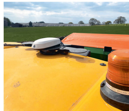
JCB bietet jetzt eine integrierte Spurführung mit Novatel-Empfänger, Lenksteuerung und Benutzeroberfläche an.
