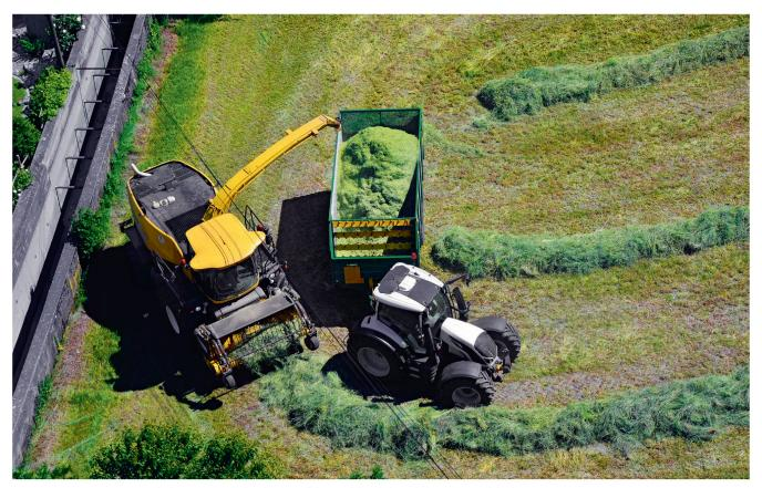
Sensorgestützte Ertragsermittlung: NIRS-Technologie auf dem Feldhäcksler wird erst zögerlich eingesetzt. Bild: R. Hunger
