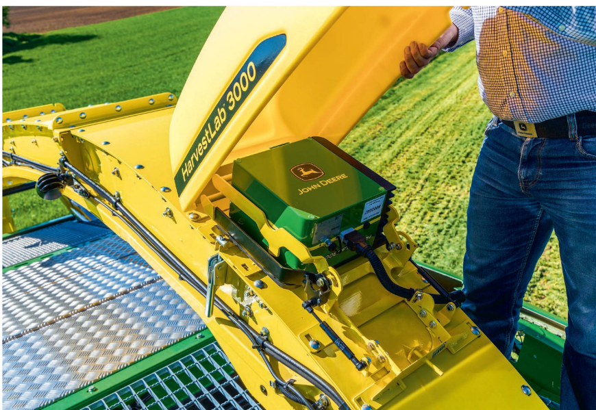
Je nach Sensor können neben der Trockenmasse auch die Inhaltsstoffe von Gras, Luzerne, Mais und Ganzpflanzensilage gemessen werden. Bild: JD
