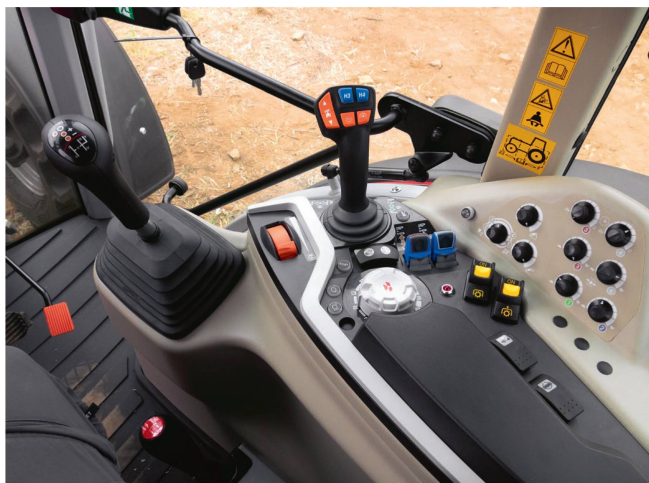
Die «Efficient»-Versionen verfügen über ein PowerShuttle- und Speedshift-Getriebe sowie einen Joystick für die Getriebe- und Hydraulik-Bedienung.
