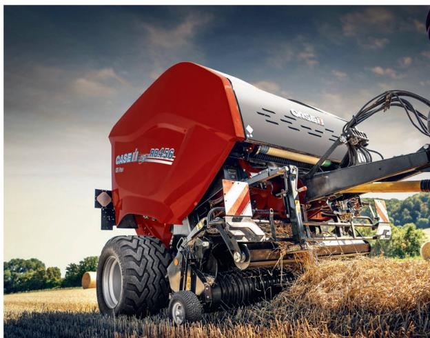
Auf der Landwirtschafts-Messe «agra» in Leipzig hat Case IH mit der «RB HD Pro» eine neue Baureihe von Hochleistungs-Rundballenpressen mit variabler Kammer vorgestellt. Die neuen Pressen gibt es in zwei Größen. Zum einen die «RB456 HD Pro» für das Pressen von 120-cm-Ballen mit Durchmessern von 90 bis 165 cm und zum anderen die «RB466 HD Pro», die ebenfalls 120 cm breit presst, aber Durchmesser von 90 bis 190 cm ermöglicht.
