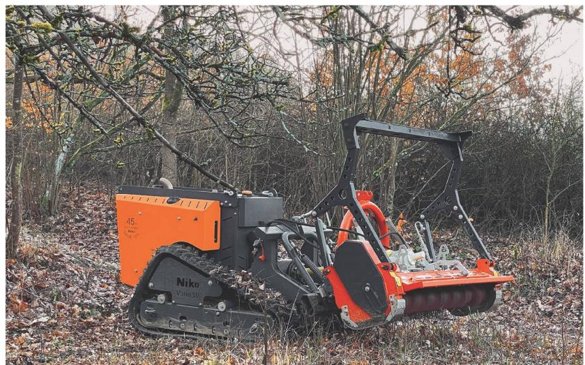
Mit dem «RoboFlail Vario D501» erweitert Rapid sein Mähraupenportfolio um eine 50 PS starke Mähraupe für den Forst und die Landschaftspflege. Für die optimale Kraftübertragung auf die Anbaugeräte wird auf eine Zapfwelle gesetzt, der Anbau selbst erfolgt über eine Kat.-1-Aufnahme. Um die Standsicherheit im Hang zu erhöhen, ist der Geräteträger mit einer positions- und seitenunabhängigen, hydraulischen Fahrwerksverbreiterung von 127 auf 175 cm ausgestattet. Ein-
