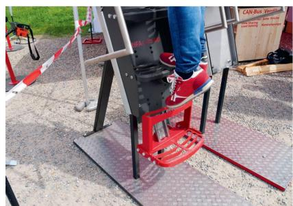
Griener Fahrzeugtechnik (D) hat mit dem «SoftStep» eine Auf- und Abstiegshilfe für Traktoren entwickelt. Es ist nicht nur eine verlängerte Treppe, «SoftStep» arbeitet wie ein Lift und lässt beim Ausstieg die Person langsam hinunterschweben. Die letzte Stufe senkt sich beim Abstieg ab.
