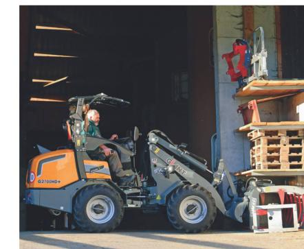
schine zudem mit Doppelrädern ausgestattet, welche insbesondere bei Arbeiten auf dem Feld zum Einsatz kommen, und durch den proportional einstellbaren Dauerumlauf ist selbst das Umpumpen von Gülle kein Problem. Die starken 12-Tonnen-Planetenachsen mit Differenzialsperre vorne und hinten sorgen auch auf rutschigem Untergrund für hohe Schubkraft und sein Knickpendelgelenk verleiht dem Giant optimale Stabilität sowie grosse Wendigkeit auf jedem Terrain.
