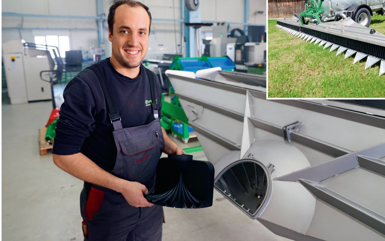
Thomas Hollenstein vor dem verschleissarmen Gülleverteiler ohne Verteilkopf und ohne Ablaufschläuche. Die Verteilung erfolgt beim «Schleppfix» (kleines Bild) rein strömungstechnisch. Bilder: D. Senn, R. Engeler
