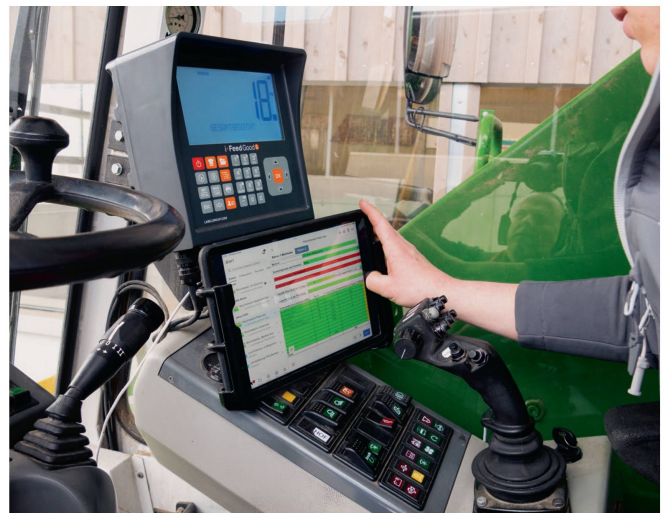
Der Fahrer hat die für jeden Betrieb notwendigen Informationen auf einem Tablet präsent. Ein Terminal (oben) überwacht sämtliche Funktionen der Maschine.
