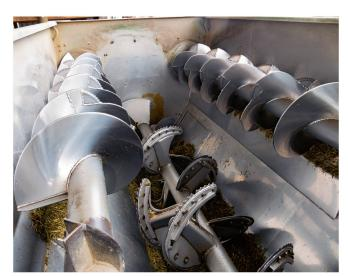
Der Mischbehälter des «Superchamp SL» fasst 14 m³ und ist aus massivem Edelstahl gefertigt. Drei horizontal angeordnete Rührflügelwellen sorgen für die Durchmischung.
