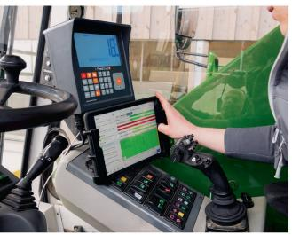
Der Fahrer hat die für jeden Betrieb notwendigen Informationen auf einem Tablet präsent. Ein Terminal (oben) überwacht sämtliche Funktionen der Maschine.
