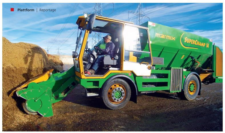
Der Lohnmischer mit dem selbstfahrenden Futtermischwagen Marmix «Superchamp» beim Befüllen aus einem Fahrsilo. Bilder: R. Engeler
