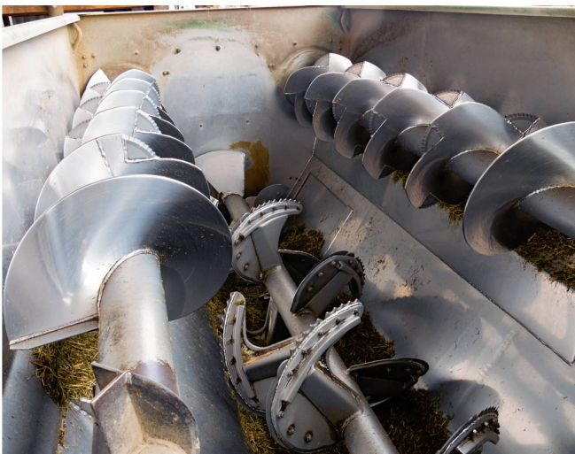
Der Mischbehälter des «Superchamp SL» fasst 14 m 3 und ist aus massivem Edelstahl gefertigt. Drei horizontal angeordnete Rührflügelwellen sorgen für die Durchmischung.
