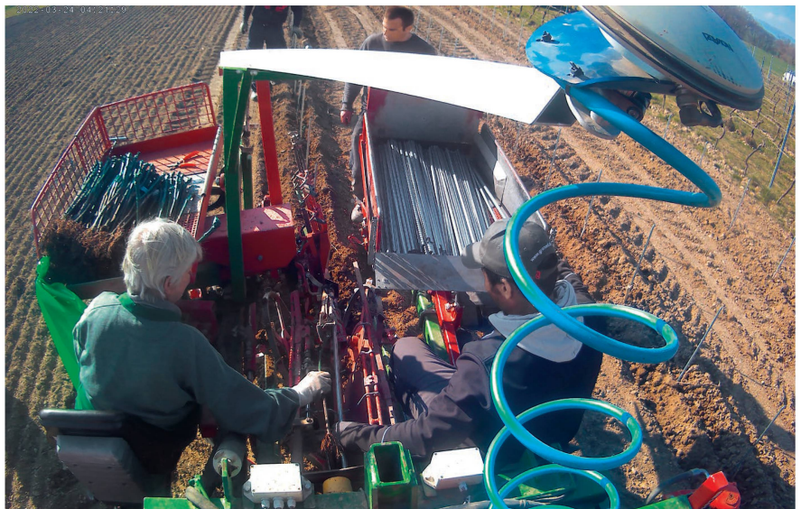
Zwei Arbeiter, die auf der Pflanzmaschine sitzen, legen die Jungreben und die Pfähle nacheinander horizontal auf das Pflanzrad. Im Vordergrund die GPS-Antenne.
