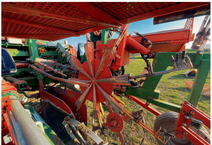
Das Pflanzrad ist mit Greiffingern ausgestattet, die die Jungpflanze und ihren Pfahl in Position halten, bis sie an ihrer endgültigen Position gepflanzt werden.
