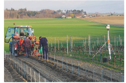
Die RTK-Basisstation korrigiert das GPS-Signal zentimetergenau.
