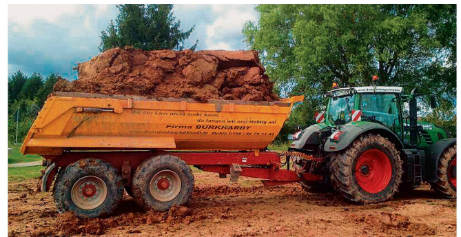
Schwer bepackter Tandemanhänger, der als Beispiel mit abnormaler Stützlast dienen soll.
