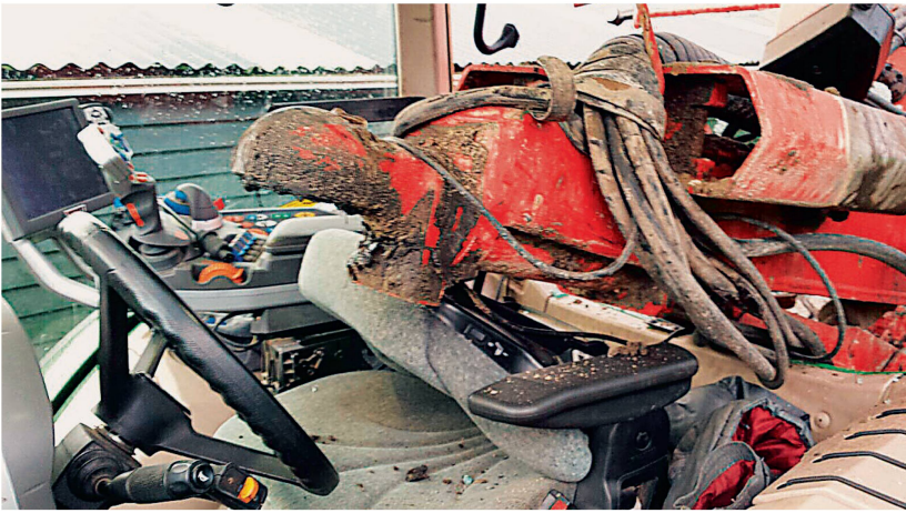
Auswirkungen negativer Stützlast sind lebensgefährlich.
