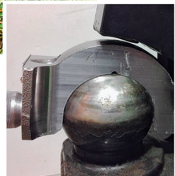
Die Walterscheid-Prüfkalotte zeigt, ob die Niederhaltereinrichtung verformt ist.
