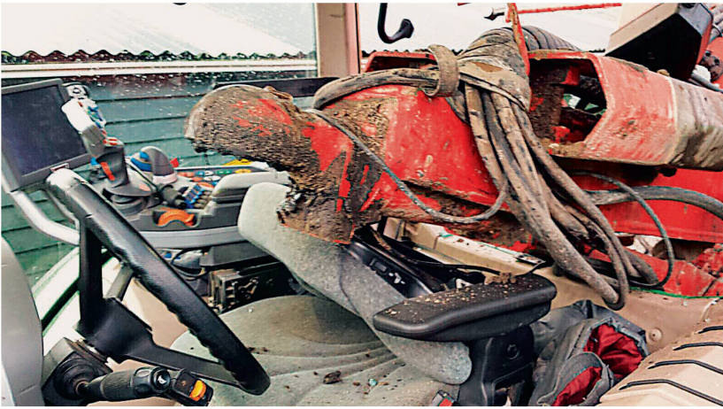
Auswirkungen negativer Stützlast sind lebensgefährlich.
