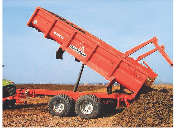
Wenn das Ladegut beim Abrutschen stockt, wird die Kalotte nach oben gedrückt.
