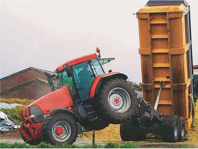
Auswirkungen negativer Stützlast: Beim Abkippen können Fahrer und Gespann gefährdet werden.
