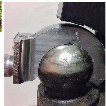
Die Walterscheid-Prüfkalotte zeigt, ob die Niederhalte-einrichtung verformt ist.
