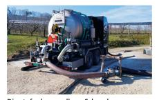
Die stufenlos regelbare Schneckenpumpe erzeugt bis zu 16 bar Druck.
