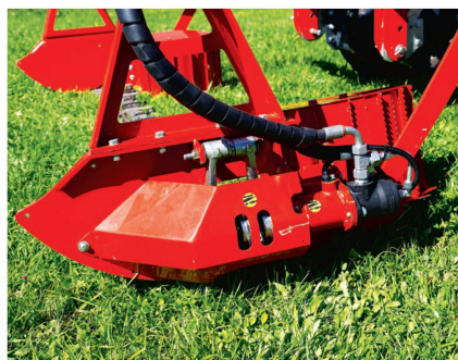
Hydraulikkomponenten und Untersetzungsgetriebe werden nach Kundenwunsch auf die Zapfwellendrehzahl des Traktors abgestimmt.
