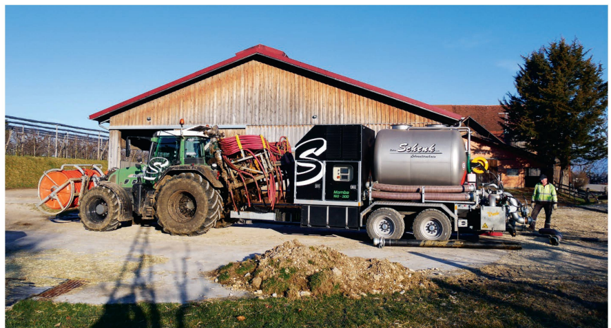
Die lange Deichsel am Pumpwagen erlaubt das Verschieben des kompletten Gespanns von einem Ort zum anderen mitsamt Schleppschlauchverteiler am Traktorheck.
