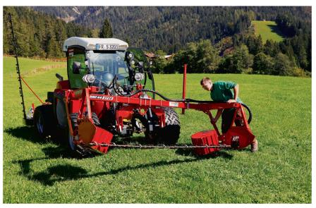
Der Frontmäher ist mit einem Kugelgelenk aufgehängt. Der Pendelweg ist gross.
