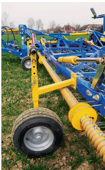
Der Druck der Zinken ist zentral hydraulisch von 100 g bis 5000 g auf 31 cm Federweg einstellbar. Die Federn werden über die gelbe Rolle vorgespannt (Bild links).
