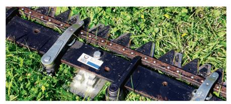
Das Schneidsystem (System Bidux) mit ungleicher Klingenteilung stammt von ESM.
