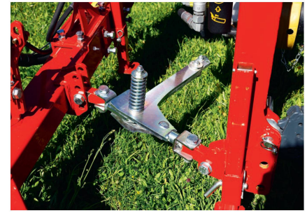
Blick auf die mechanische Anfahrssicherung des Heckmähers.
