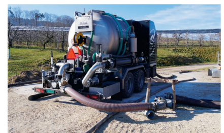
Die stufenlos regelbare Schneckenpumpe erzeugt bis zu 16 bar Druck.
