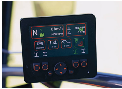
Die Drehzahl lässt sich mit diesem Display in der Kabine anzeigen.
