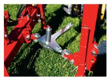
Blick auf die mechanische Anfahrsicherung des Heckmähers.
