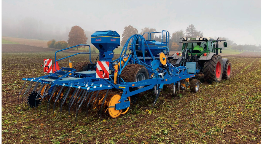
Der Präzisions-Grubber «TG 300» beim Winterweizensäen nach Zuckerrüben. Bild: zvg
