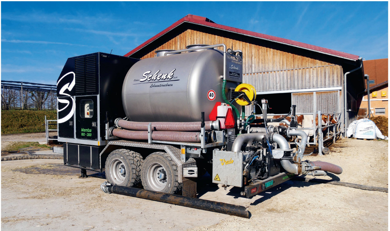
Die Güllepumpe «Mamba 160-300» hat einen 6-Zylinder-Motor mit 312 PS Maximalleistung und einen 5000-Liter-Tank mit zwei Kammern für Flüssigdünger und Wasser. Bilder: Heinz Röthlisberger
