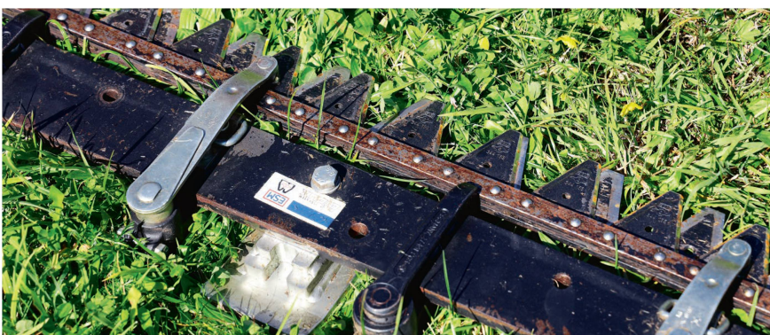
Das Schneidsystem (System Bidux) mit ungleicher Klingenteilung stammt von ESM.
