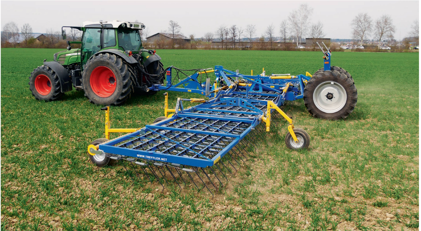
Der Treffler-Präzisions-Zinkenstriegel «TS 1220 M3» beim Einsatz in Seuzach ZH. Mit Fahrwerk wird der 12,2-Meter-Striegel an den Unterlenkern angehängt. Bilder: Heinz Röthlisberger
