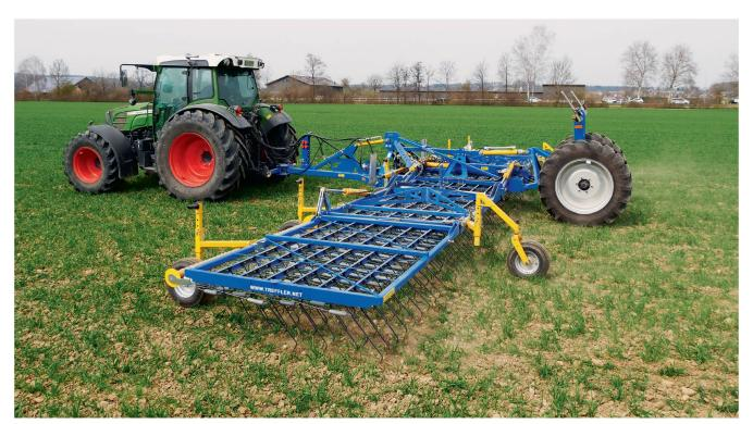
Der Treffler-Präzisions-Zinkenstriegel «TS 1220 M3» beim Einsatz in Seuzach ZH. Mit Fahrwerk wird der 12,2-Meter-Striegel an den Unterlenkern angehängt. Bilder: Heinz Röthlisberger
