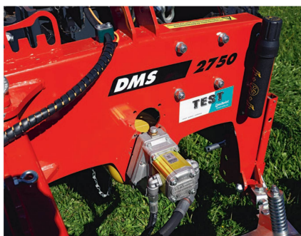
Hydraulikkomponenten und Untersetzungsgetriebe werden nach Kundenwunsch auf die Zapfwellendrehzahl des Traktors abgestimmt.
