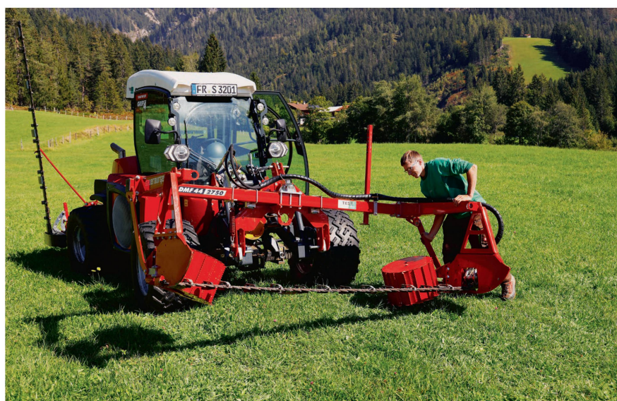
Der Frontmäher ist mit einem Kugelgelenk aufgehängt. Der Pendelweg ist gross.
