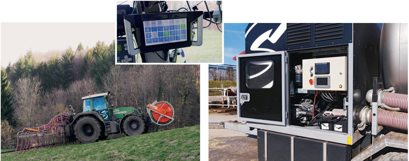
Über die Funkfernsteuerung «ProfiPilot» kann der Fahrer die Pumpe aus der Ferne steuern und überwachen. So etwa Durchfluss, Düngerdosierung und Motorendaten. Rechts die Steuerungseinheit an der Pumpe.
