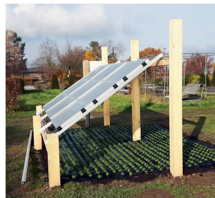
Versuchsanlage der ZHAW in Wädenswil. Unter den Photovoltaik-Modulen wächst Nüsslisalat. Bild: ZHAW
