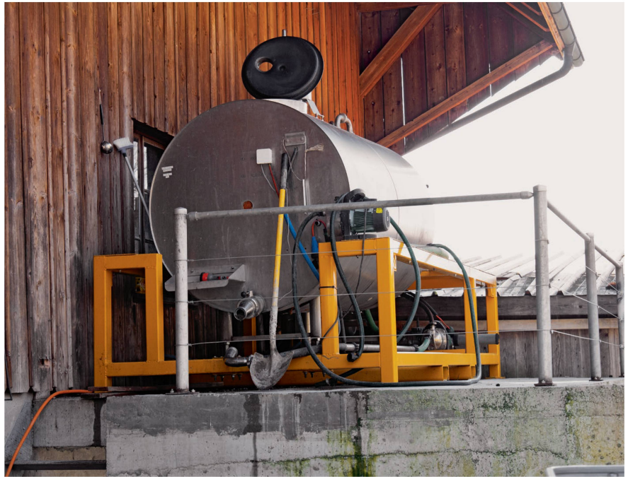
Brauen von Komposttee bei Zurbuchen Bodenschutz (Lippoldswilen TG) in einem 2000-Liter-Tank: Das eingefüllte Wasser wird elektrisch auf 20 Grad erhitzt, erwärmt sich dann selbst weiter auf 28 Grad.
