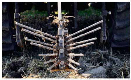
Dieses Multifunktionswerkzeug ist das wichtigste Gerät für den Dammaufbau. Bild: R. Hunger
