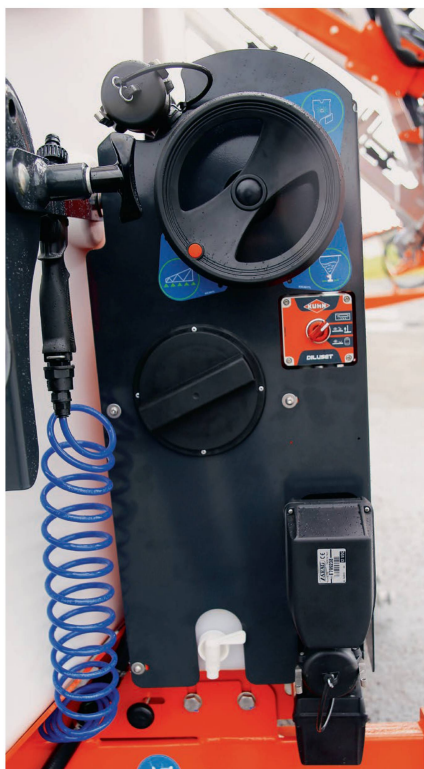
Das «Diluset+»-Bediensystem besteht aus einem manuellen Druckventil (oben) und einem motorbetriebenen Saugventil (unten).
