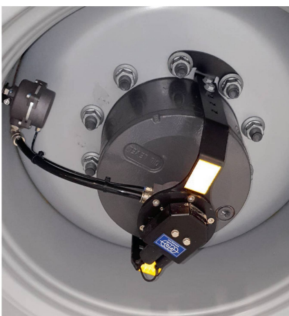
Systeme mit aussenliegenden Drehdurchführungen: im Bild oben eine 1-Leiter-Anlage, unten eine 2-Leiter-Anlage an einem MF «8S», bei welcher die Schläuche nicht angekoppelt sind. Bilder: STG und Mario Stettler
