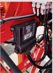
Die «Autospray»-Funktion wird durch eine «PWM»-Magnetspule gewährleistet, die die Öffnung jedes Düsenhalters steuert (oberes Bild) und von einem Bordcomputer am Parallelogramm des Gestänges gesteuert wird (unteres Bild).
