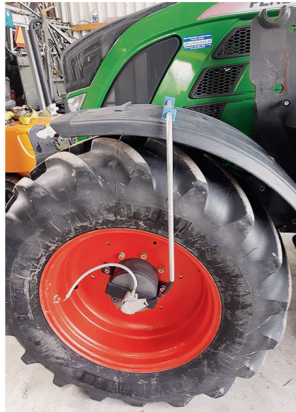
Bei der 1-Leiter-Reifendruckverstellanlage von Téléflow ist die Drehdurchführung mit einem speziellen Radventil kombiniert. Bild: Agrosam
