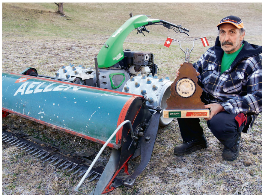
Mit seinem wirkungsvollen «Spiralzinkenrotor» als eine Art Aufbereiter für Balkenmäher gewann Jakob Aellen in der Kategorie «Tüftler».
