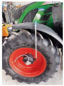
Bei der 1-Leiter-Reifendruckverstellanlage von Téléflow ist die Drehdurchführung mit einem speziellen Radventil kombiniert. Bild: Agrosam
