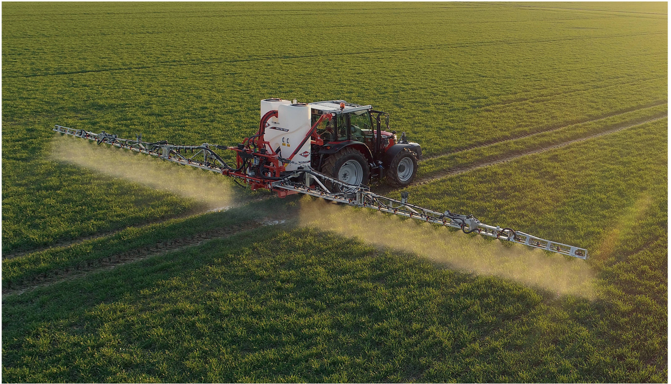
Die Feldspritze Kuhn «Deltis 2» verfügt über ein Spülsystem zur Innenreinigung, das von der Kabine aus bedient werden kann und mit den Anforderungen des Bundesamtes für Landwirtschaft kompatibel ist. Bild: Kuhn
