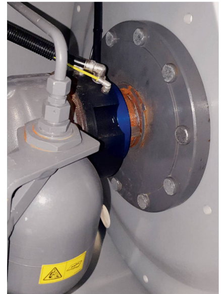
Innenliegende Drehdurchführung der 2-Leiter-Anlage von PTG am MF «8S». Bild: Mario Stettler
