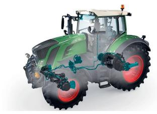
Mit «VarioGrip» bietet Fendt eine eigene 2-Leiter-Reifendruckverstellanlage ab Werk an. Bild: Fendt
