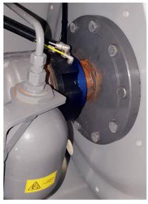
Innenliegende Drehdurchführung der 2-Leiter-Anlage von PTG am MF «8S».
