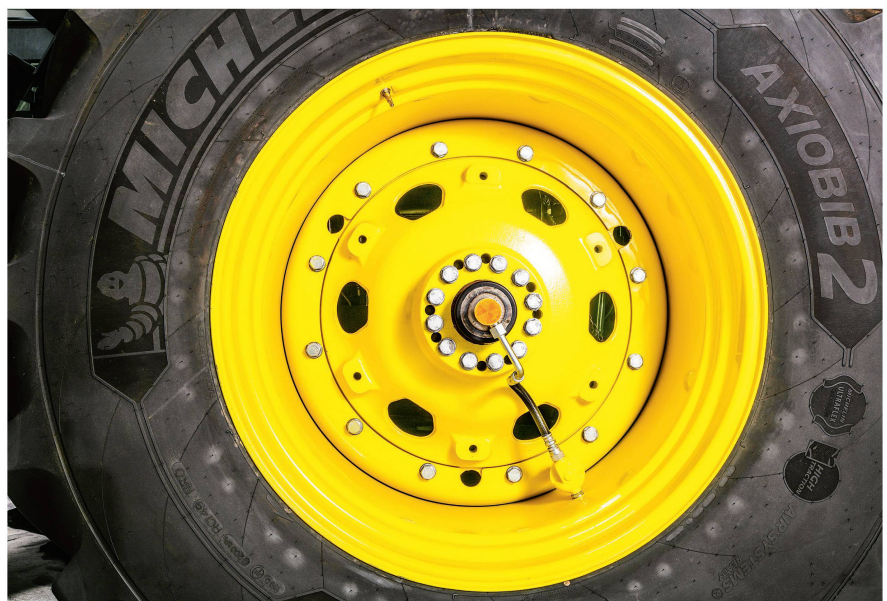
Die Reifendruckverstellanlage von John Deere für die Serie «8R» arbeitet nach dem 1-Leiter-Prinzip. Bild: John Deere
