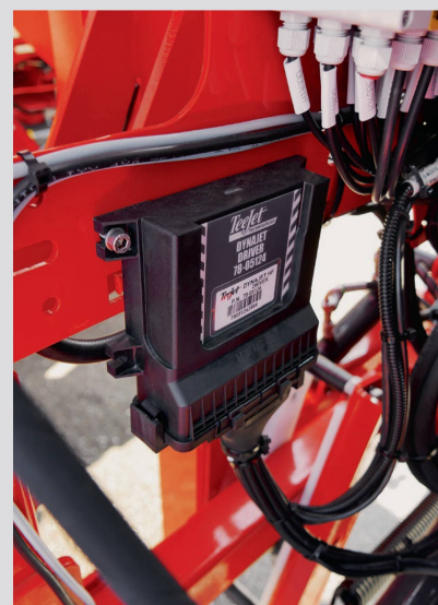
Die «Autospray»-Funktion wird durch eine «PWM»-Magnetspule gewährleistet, die die Öffnung jedes Düsenhalters steuert (oberes Bild) und von einem Bordcomputer am Parallelogramm des Gestänges gesteuert wird (unteres Bild).
