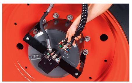
Die fünf Leitungen beim System «CTIC» von Claas können abgekoppelt und auf dem Kotflügel «parkiert» werden. Bild: Claas
