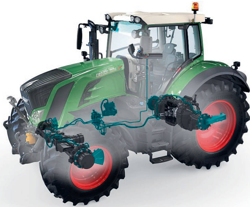
Mit «VarioGrip» bietet Fendt eine eigene 2-Leiter-Reifendruckverstellanlage ab Werk an. Bild: Fendt
