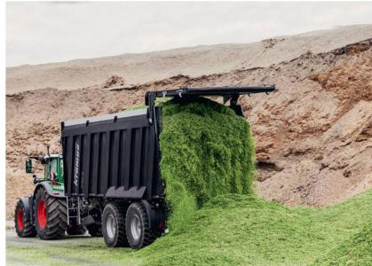
Der erste Krampe-Abschieber mit dem Produktnamen «RamBody» und der Typenbezeichnung «AS 750» wird zunächst als Tandemanhänger mit einem Ladevolumen von 41,1 m<sup>3</sup> produziert. Neben der serienmässigen Parabelfederung, einem Fahrwerk mit hydraulischem Achsausgleich gibt es auch eine luftgefedeerte Version. Als Alleinstellungsmerkmal wer-
