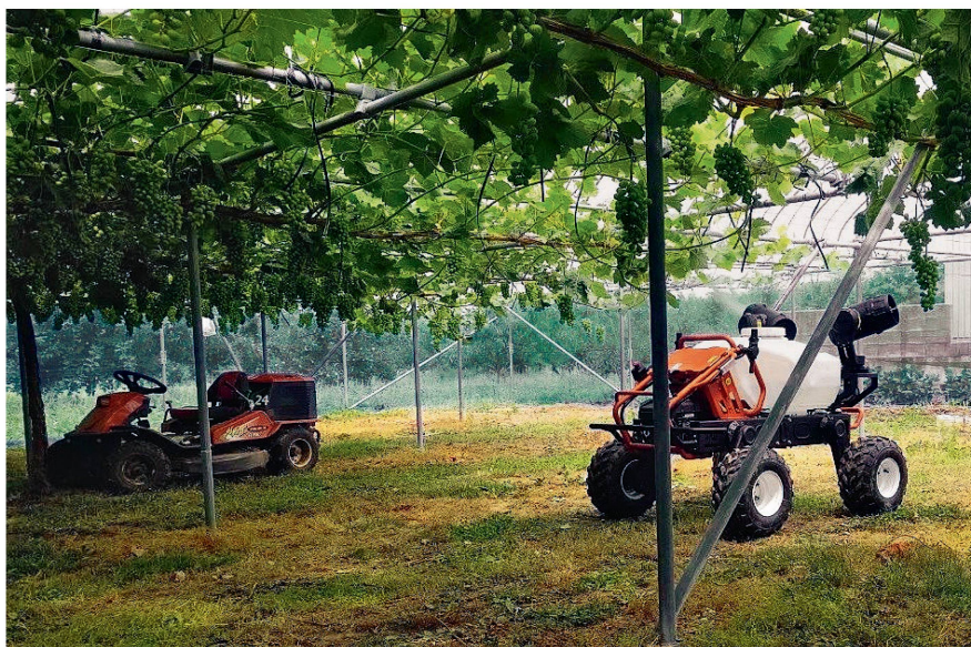
Der Roboter «Rover 150» kann für verschiedene Arbeiten, vor allem in Spezialkulturen, eingesetzt werden. Bilder: STI
