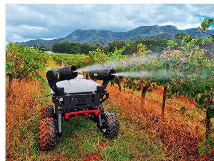
Ausgestattet mit dem «JetSprayer»-System soll der «Rover 150» Pflanzenschutzmittel völlig autonom in einer Effizienz von 5 Hektar pro Stunde ausführen können.
