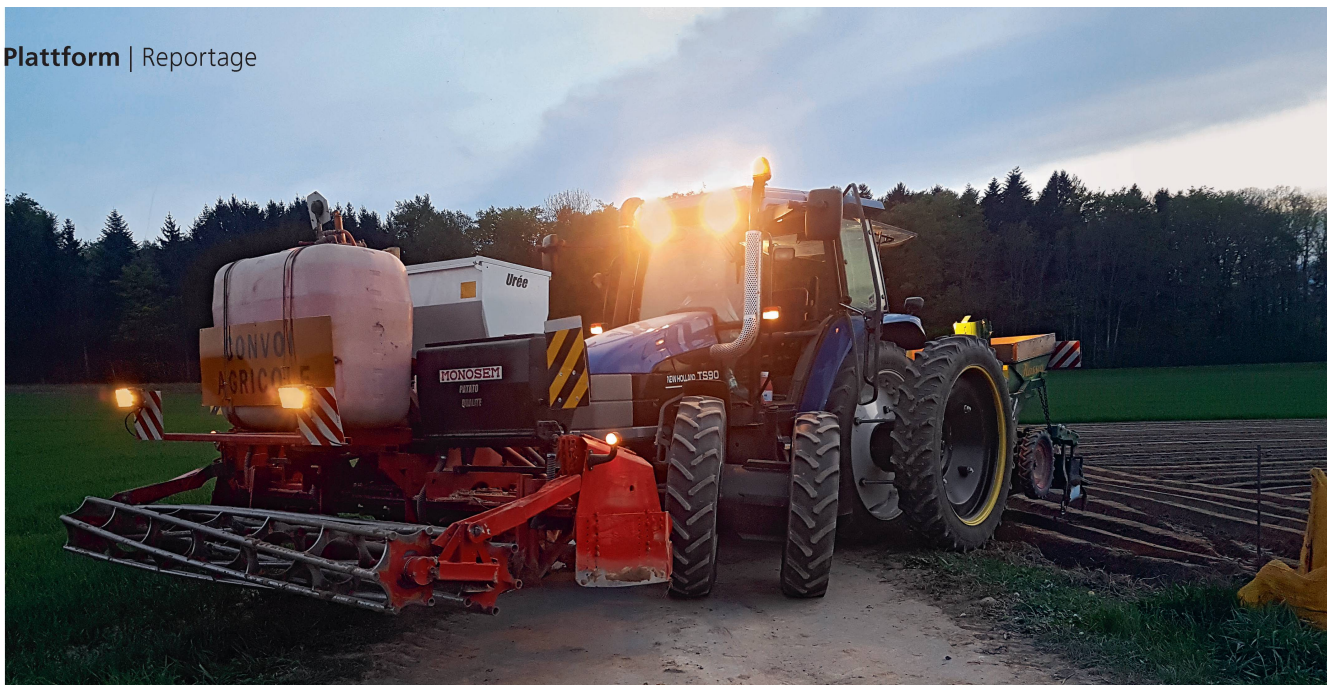
Die Eigenkreation «Patatop» von Madrick Bonny ist in der Lage, bei der Anlage von Reihenkulturen eine Unterfussdüngung und sogar eine erste Pflanzenschutz-Behandlung in nur einem Durchgang zu erledigen. Bild: M. Bonny / F. Bastian
