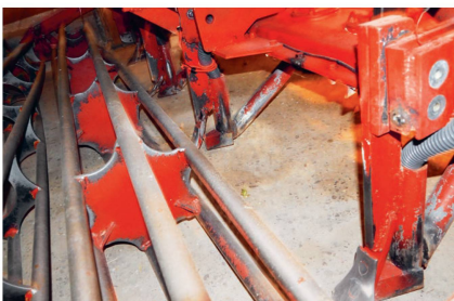
Hinter zwei Stabwalzen öffnen die vier Schare die Erde, der Dünger wird so in der gewünschten Höhe abgelegt. Bild: M. Schubnel
