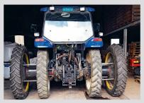
Diese selbst gebauten Doppelräder sind nötig, um das schwere Frontgerät «Patatop» zu tragen.
