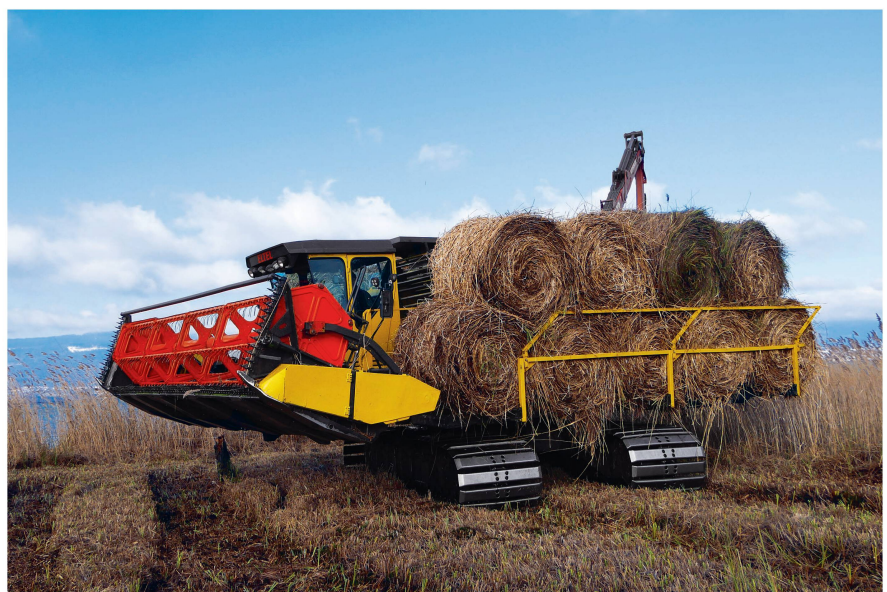
Auf dem wenig tragfähigen Sumpfland können die Richtungswechsel am Ende der Parzelle in wenigen Sekunden mit einer 180°-Drehung des Oberwagens erreicht werden. Dadurch entstehen möglichst wenig Bodenschäden durch Manöver.
