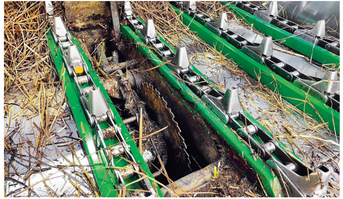
Mit diesem Sägeblatt kann man bei Bedarf den grössten Teil des Ballens in zwei identische Hälften zersägen. Damit wird die spätere Verwertung des Ballens erleichtert.
