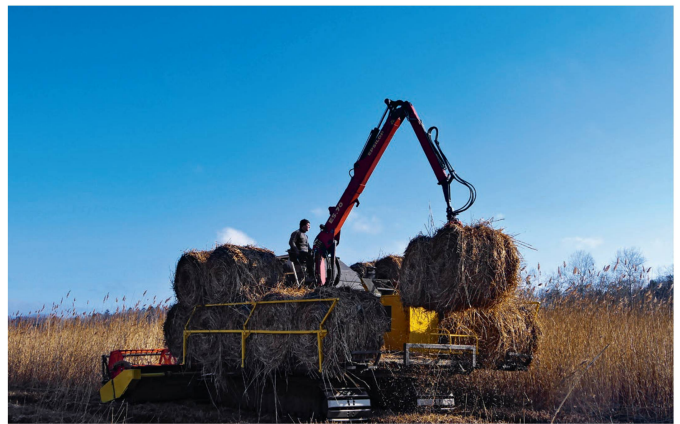
Das Stapeln der zweiten Lage mit dem Kran unterbricht den Pressvorgang vorübergehend. Dieser Vorgang ermöglicht es aber, insgesamt 22 Rundballen zu laden.
