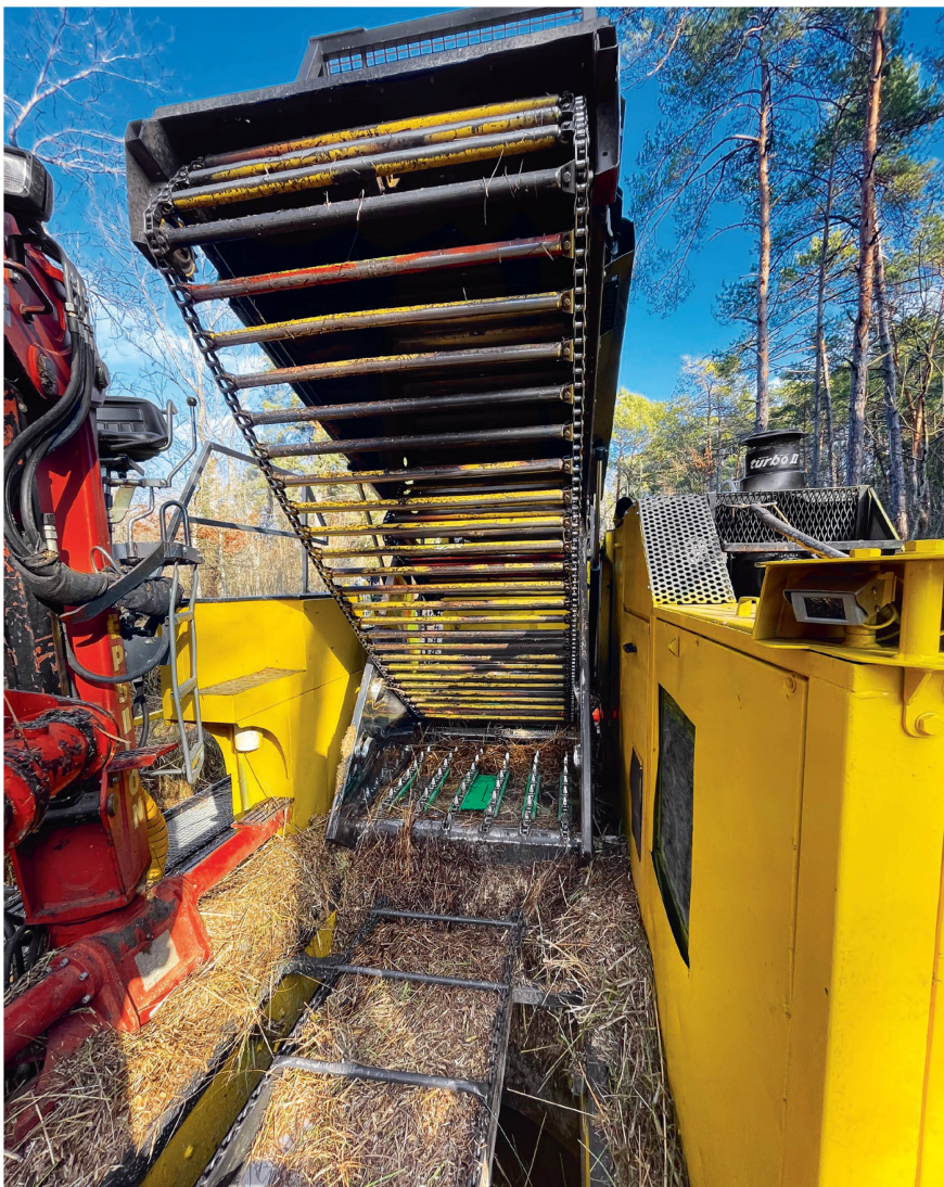
Die direkt hinter der Kabine montierte Presskammer (hier mit offener Tür) mit den Ketten und den Stäben. Die Stäbketten können, im Gegensatz zu Riemen, den scharfen Kanten des Schilfes standhalten.
