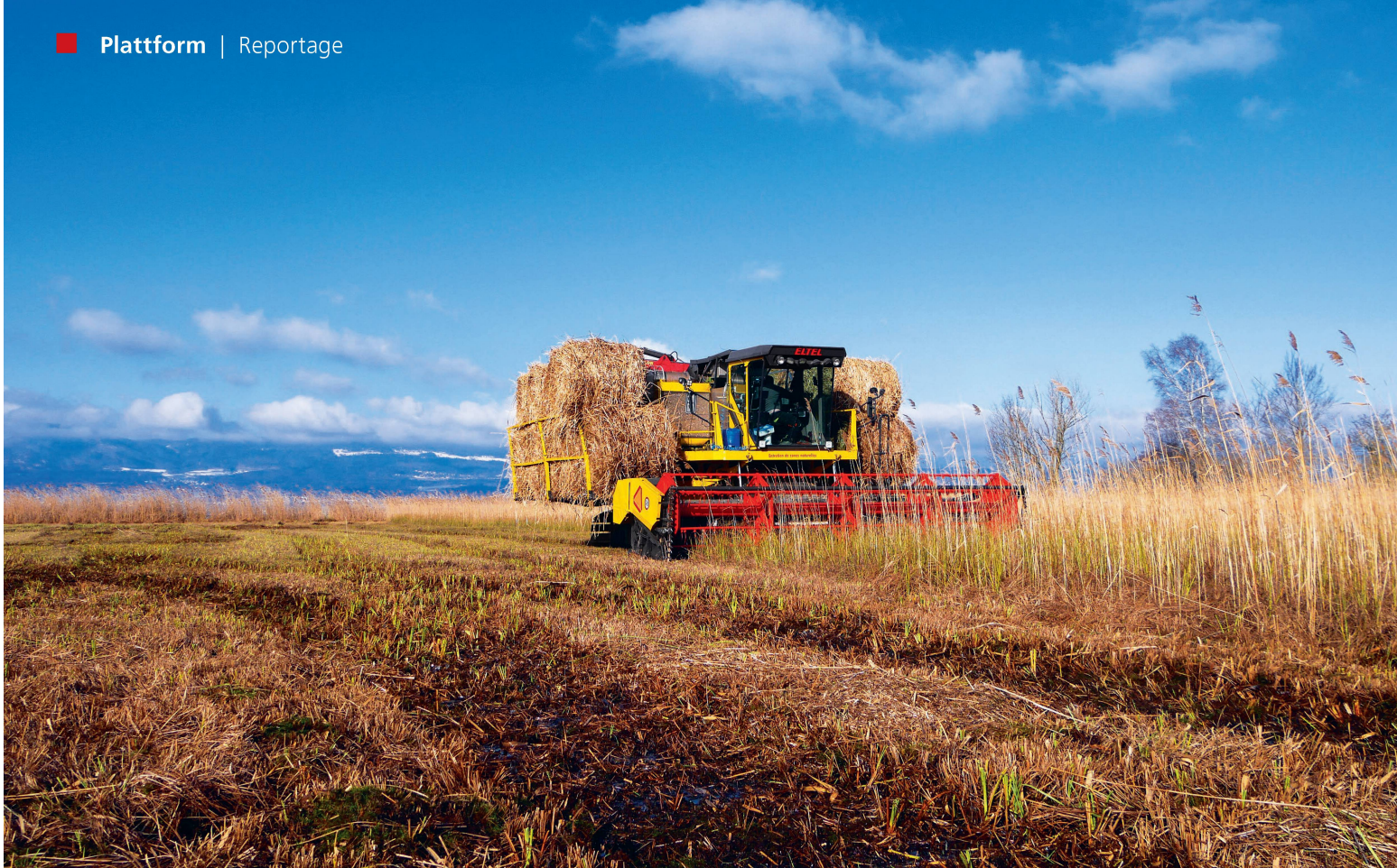
Mit der Erntemaschine «Elbotel» mäht die Firma Eltel SA am Neuenburgersee jedes Jahr 50 bis 60 ha Schilf. Die Maschine mit aufgebauter Rundballenpresse kombiniert das Mähen, das Einsammeln und das Pressen des Schilfes sowie den Abtransport der Ballen. Bilder: Matthieu Schubnel
