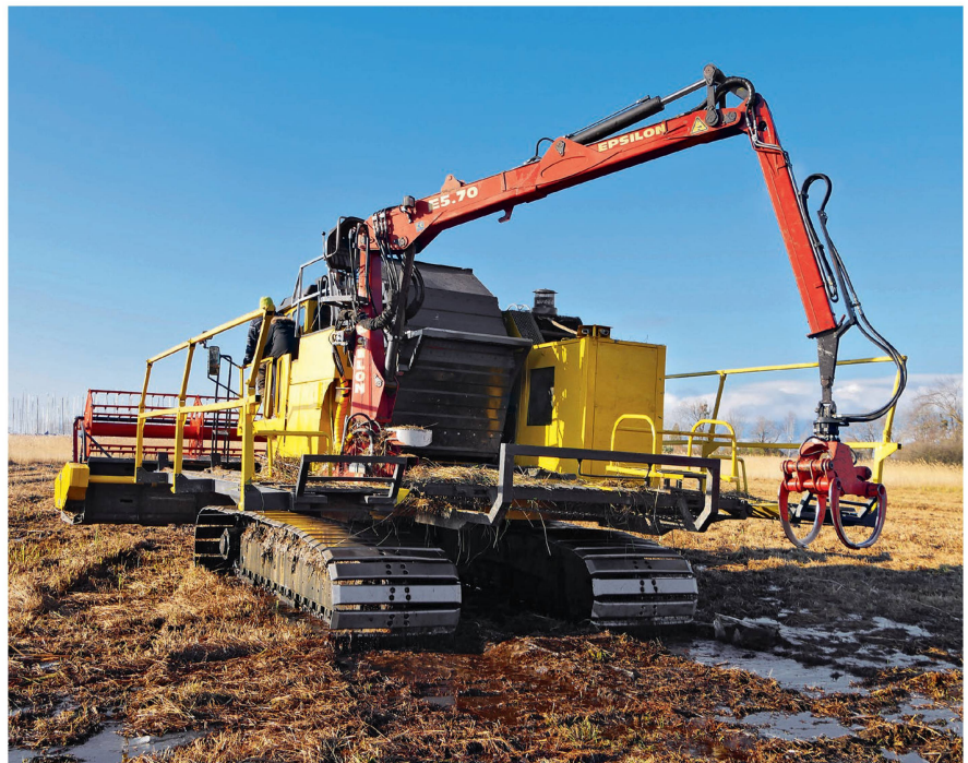
Basis des Schilfernters ist ein Bagger mit zwei breiten Raupen und einem Oberwagen. Darauf montiert ist eine Rundballenpresse. Das Leergewicht beträgt 19 Tonnen.
