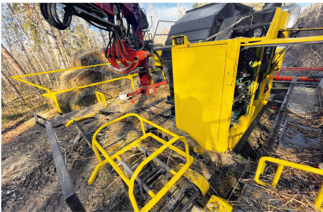
Hinter der Presse werden die Ballen mit einer von der Kabine aus gesteuerten Vorrichtung zu den beidseits montierten Ballenträgern transportiert. Bei diesem Vorgang wird die erste Lage gebildet.
