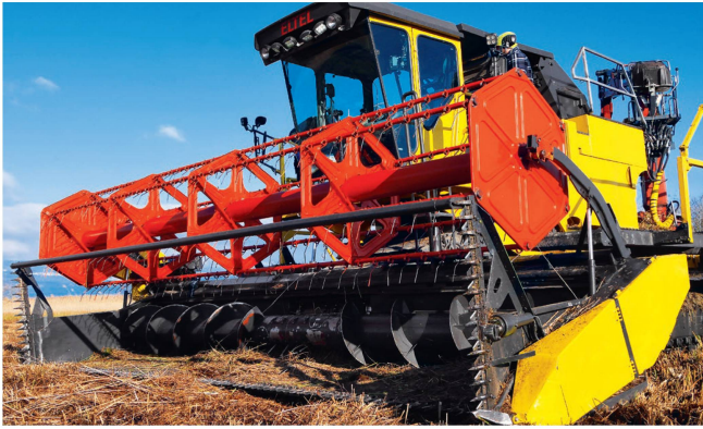
Das Schneidwerk ähnelt dem eines herkömmlichen Mähdreschers. Haspel und Schneidwerksverlängerungen durchtrennen das vom Wind niedergedrückte Schilf.
