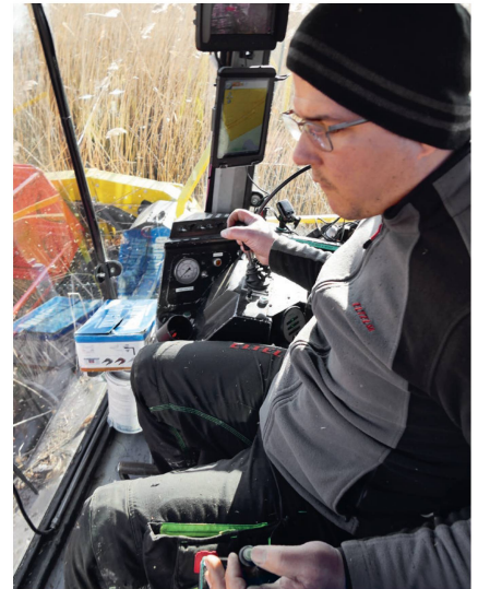
Fahrer Alejandro Lopez überwacht den GPS-Bildschirm, der aufzeigt, welche Parzellen gemäht werden müssen. Zudem gibt es zwei Heckkamera-Bildschirme.
