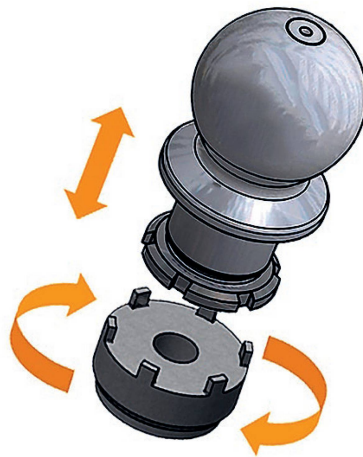
Austausch einer Walterscheid-Kugel.
