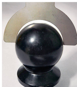
Vergleich einer Kugel «K80» im Neuzustand und bei entstandenem Verschleiss (rechts).
