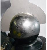
Vergleich einer Kugel «K80» im Neuzustand und bei entstandenem Verschleiss (rechts).
