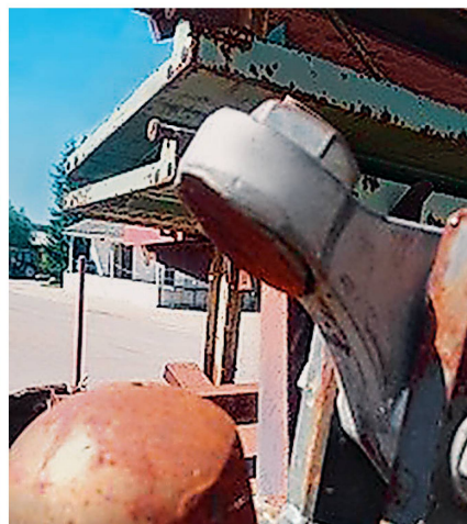
Einseitiger Verschleiss der Kugel, verursacht durch falsche Einstellung des Niederhalters.
