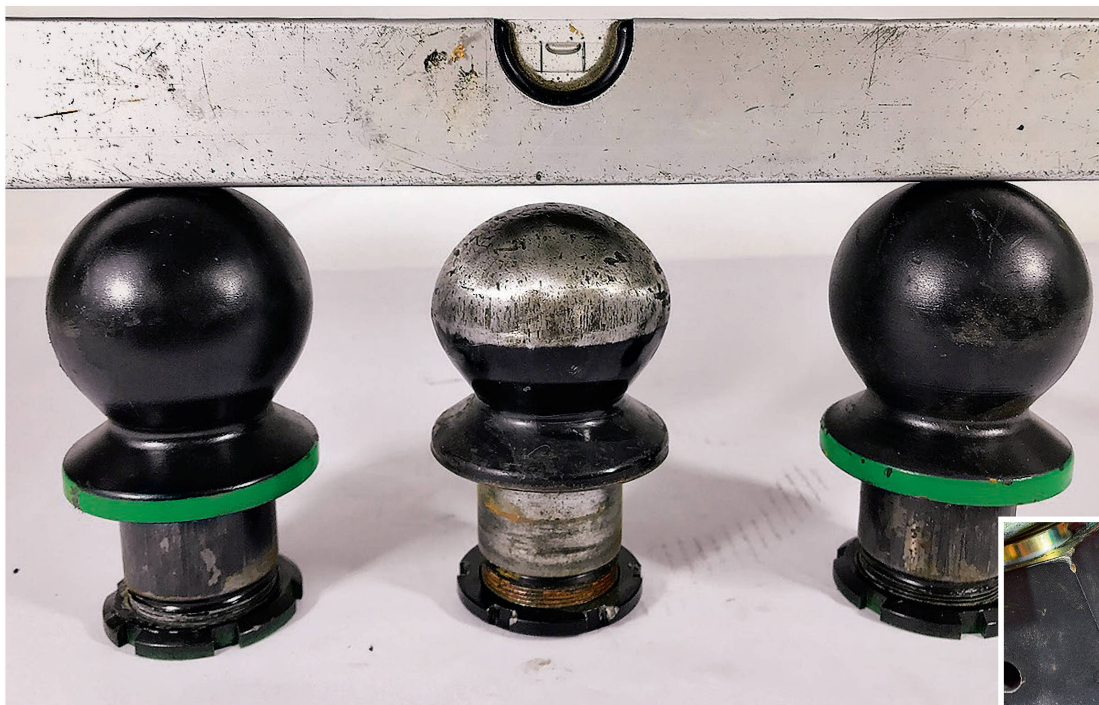
Die Kugel in der Mitte ist ein beeindruckendes Beispiel der «Kugelseuche». Bilder: Walterscheid
