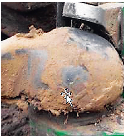
Einseitiger Verschleiss der Kugel, verursacht durch falsche Einstellung des Niederhalters.
