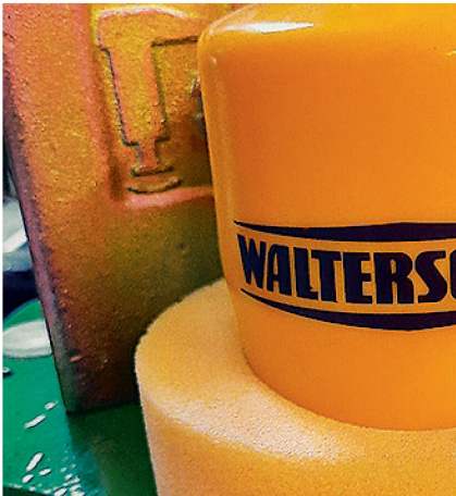
Ein Staubring schützt den Schmierfilm.
