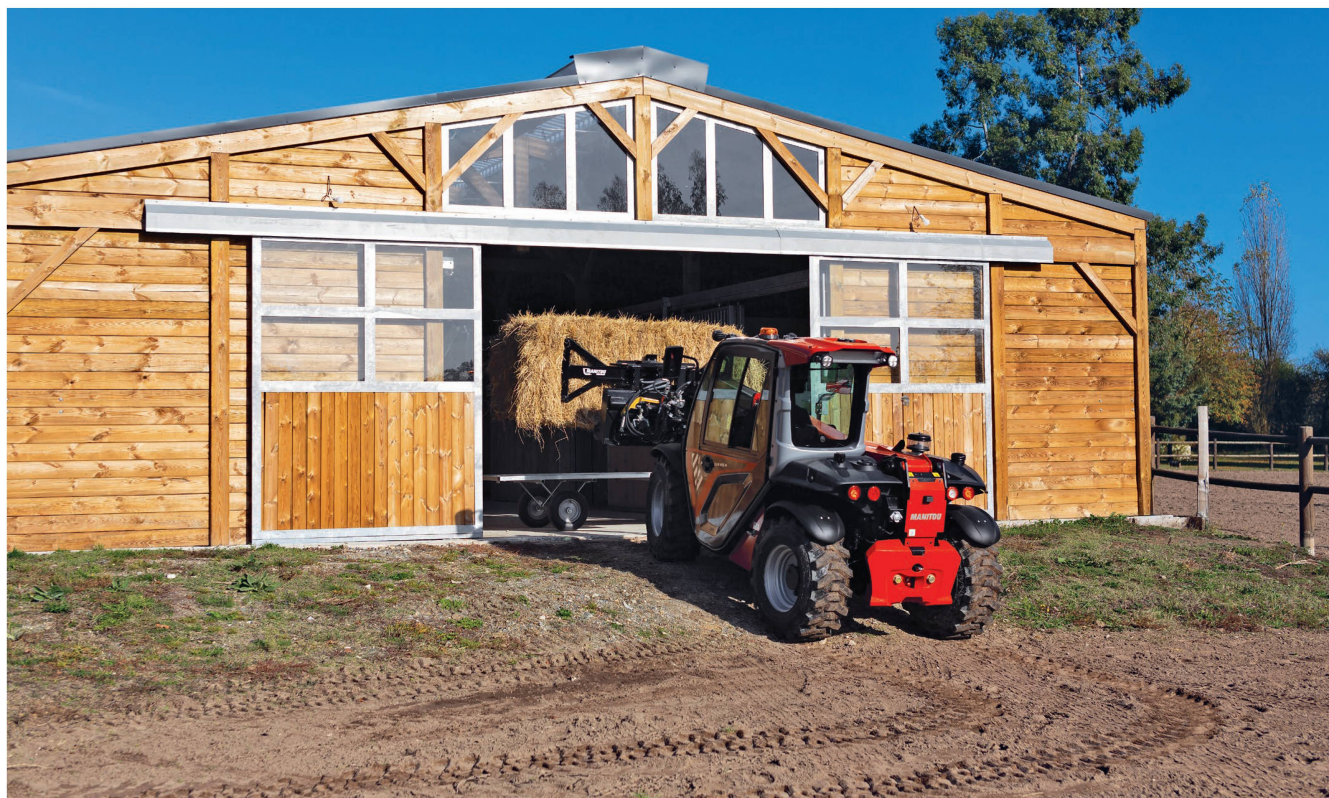
Der neue Kompakt-Teleskopplader «ULM» von Manitou mit 35-PS-Motor und 2550 kg oder 2900 kg Betriebsgewicht. Bild: Manitou
