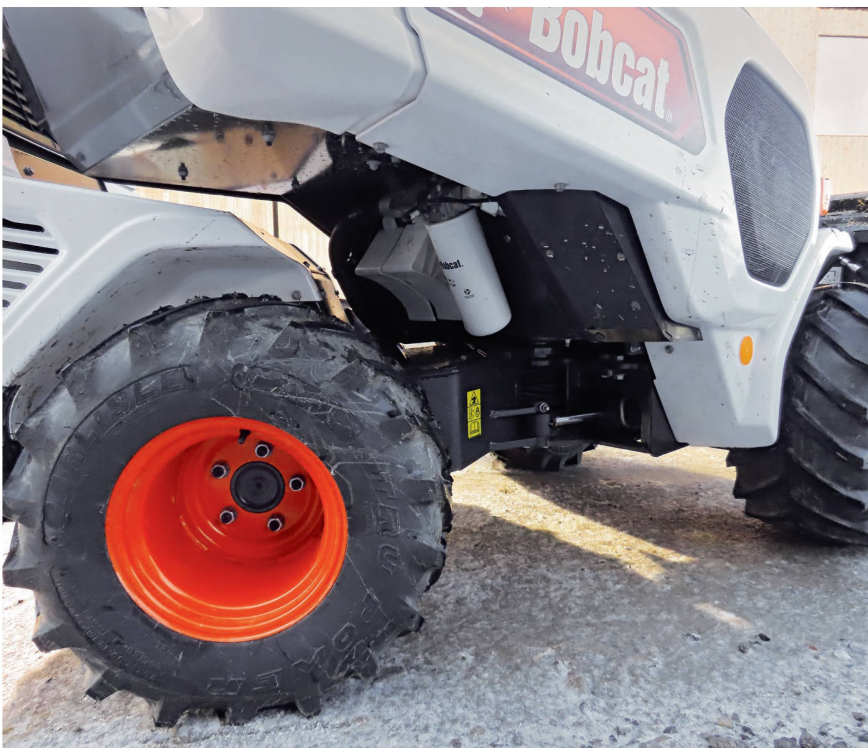
Das massiv gebaute Knickgelenk verfügt über keinen Pendelausgleich.
