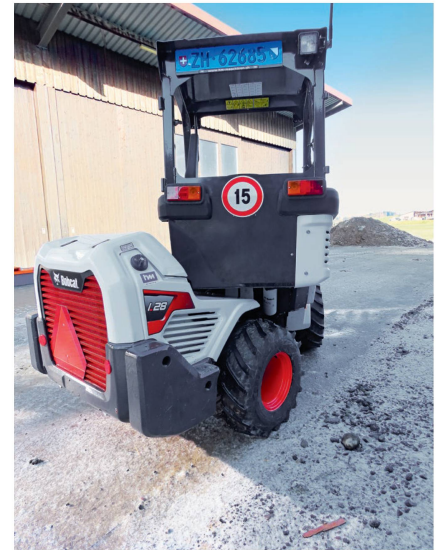
Durch den Drehpunkt unter der Kabine ist der Lader wendig, aber trotzdem in der Ebene standsicher.
