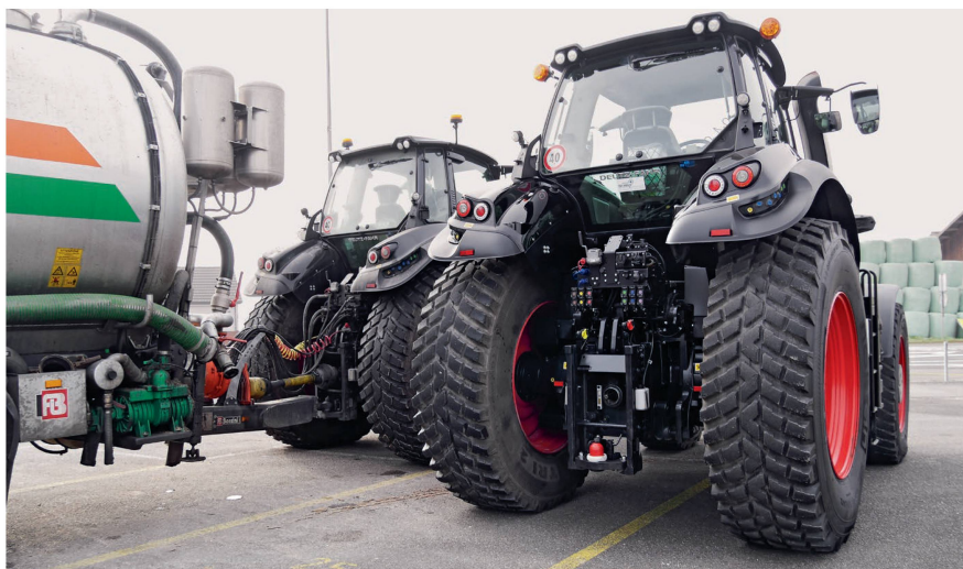
An den Transport-Traktoren wird bei Agromesser jeweils die Hydraulik abmontiert. Damit wird Gewicht gespart. Zum Einsatz kommen Strassenreifen von Nokian.
