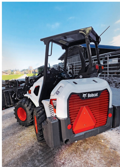
Mit den Gewichten im Heck steht der Lader sicher, ist ohne Ladung aber hecklastig.
