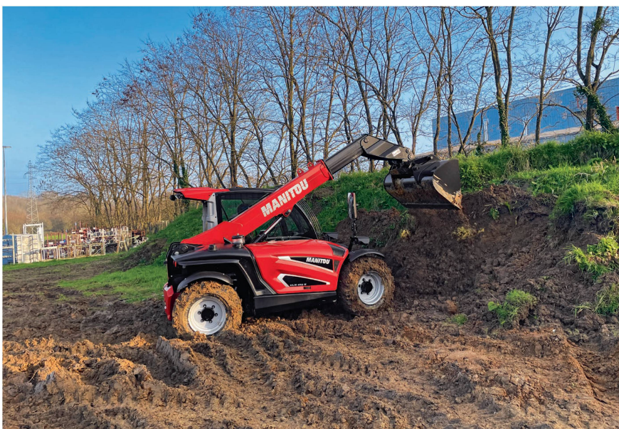
Mit Allradgetriebe und der Bodenfreiheit von 29 cm haben die «ULM»-Modelle auch gute Eigenschaften für den Geländeeinsatz. Bild: M. Schubnel
