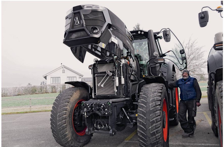
Die Motorhaube lässt sich automatisch per Knopfdruck öffnen.
