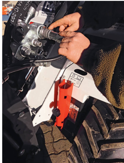
Die flachdichtenden Steckkupplungen mit integrierter Druckentlastung haben prima funktioniert.
