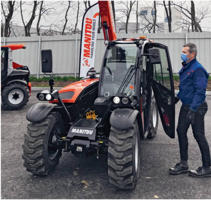
Mit einer Höhe von 1,92 m und einer Breite von 1,49 m überzeugt der «ULM» durch seine Kompaktheit. Bild: M. Schubnel
