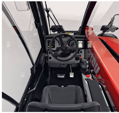
Die Kabine hat eine Breite von 66 cm. Die meisten Bedienfunktionen stammen aus den grossen Modellen. Bild: Manitou
