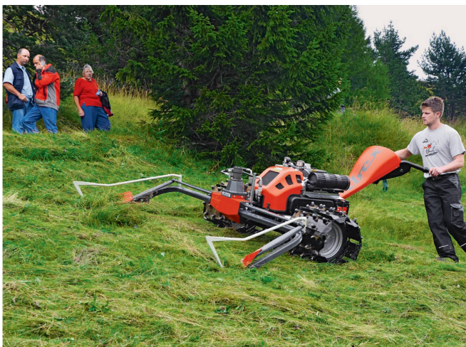
Insektenschonendes Mähen ist möglich. Doppelmessermähbalken gibt es von allen Motormäher-Herstellern.
