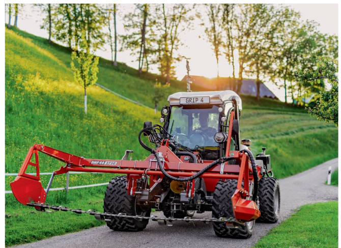
Doppelmessermähdwerke für Zweiaxsmäher sind modular ausbaubar bis zum dreiteiligen «Schmetterling».
