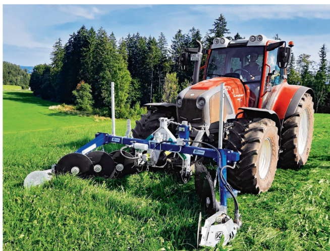
Schwadscheiben am Frontmähdwerk verhindern ein Überfahren des Futters durch den Traktor.
