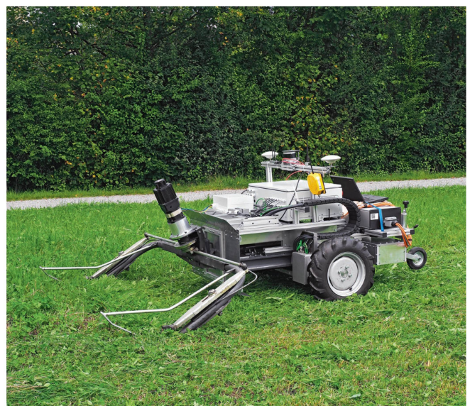
Ganz entscheidend beim autonomen Mähen ist die Steuerung der Balkenauflagekraft.
