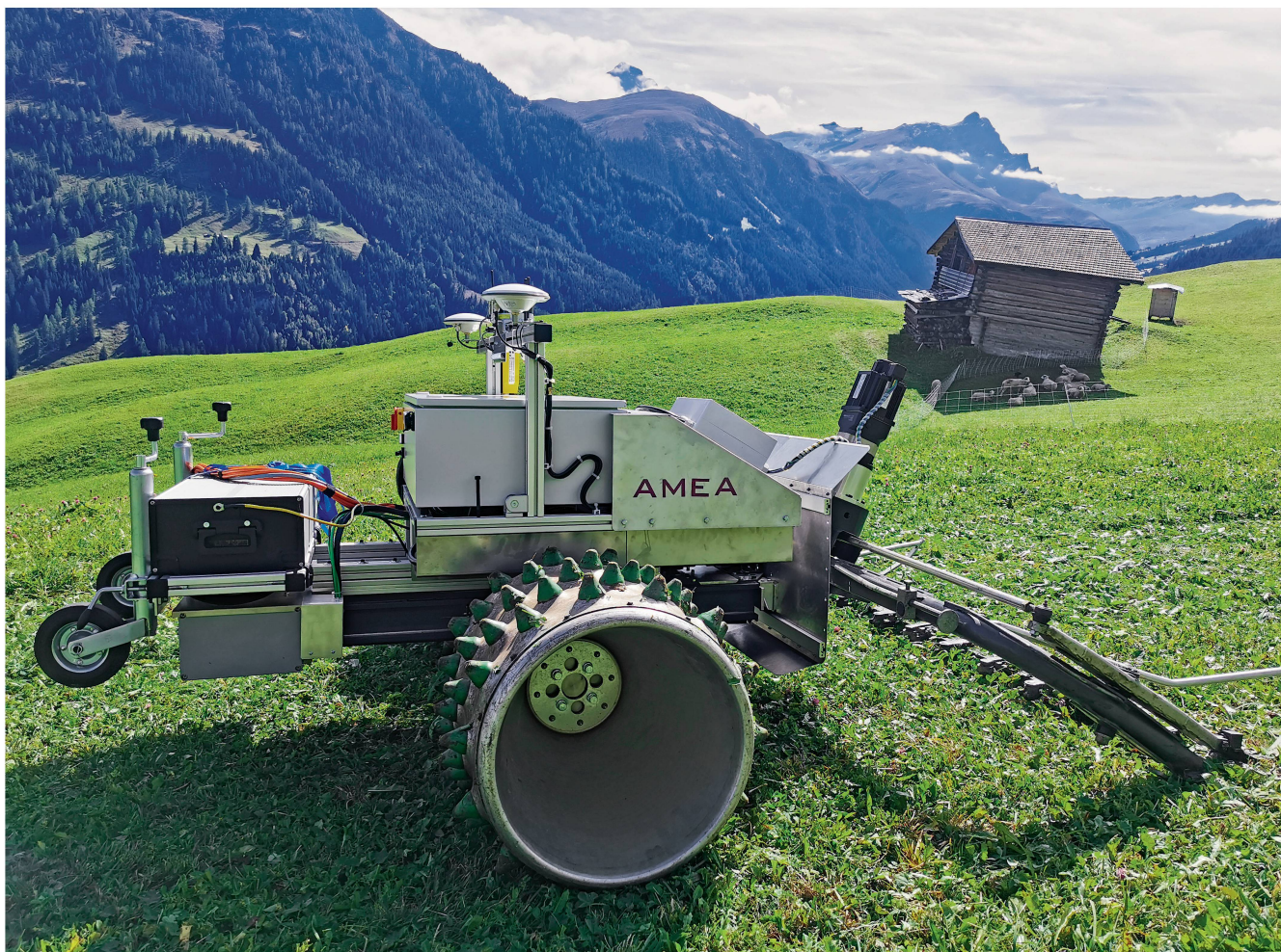
Autonomes Mähen an Hang- und Steillagen ist eine besondere Herausforderung. Der «AMEA» ist ein autonomer und hangtauglicher Einachsgeräteträger mit elektrischem Antrieb. Bilder: Altatek GmbH
