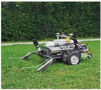
Ganz entscheidend beim autonomen Mähen ist die Steuerung der Balkenauflagekraft.
