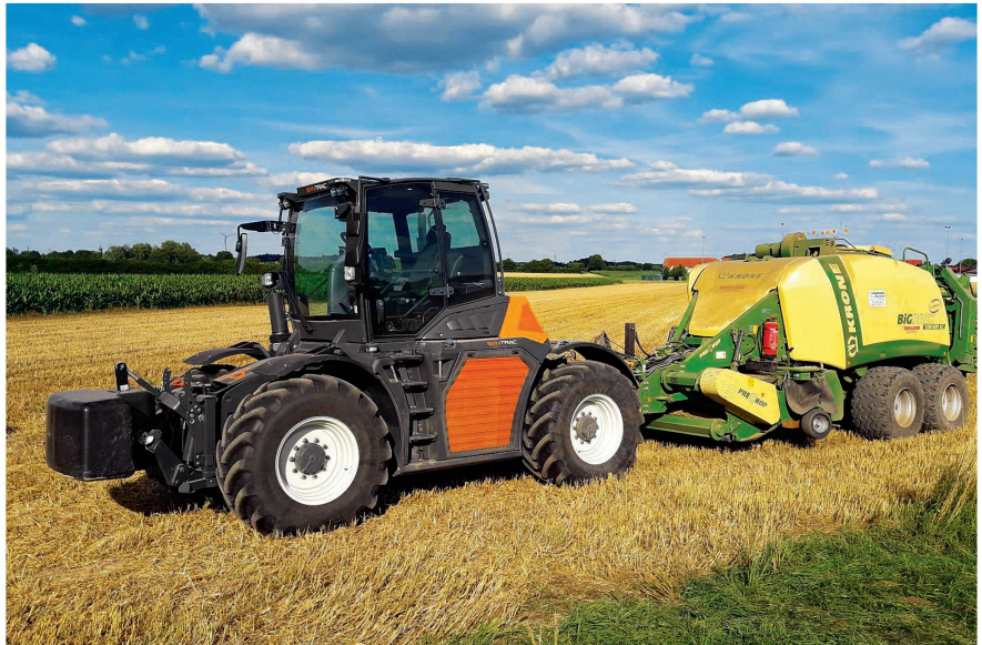
Eigenwillig und durchdacht, der «Syn Trac» mit zwei identischen Front-/Heck-Dockstationen.
