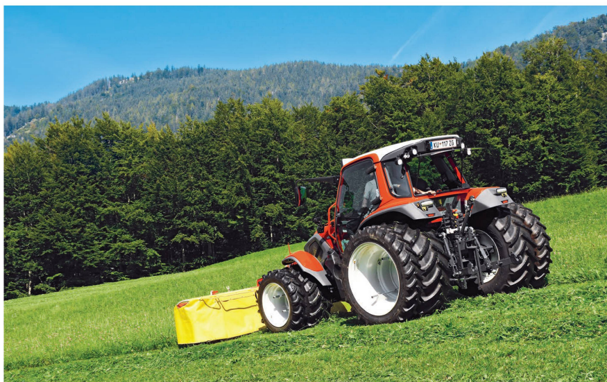
Der «Lintrac 100» ist mit seinem tiefen Schwerpunkt, exzellenter Wendigkeit und Stufenlos-Technologie bestens für die Bergmechanisierung geeignet. Bild: R. Hunger
