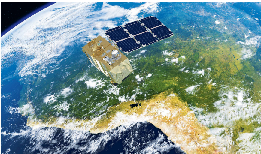
Die Stärke der Radar-Satelliten («Sentinel-1») liegt darin, dass sie auch bei Regen, Nebel und Dunkelheit zuverlässige Daten liefern. Bild: Cropix
