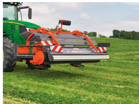
Der «Merge Maxx 440F» wird auf zwei rotierenden und in der Höhe einstellbaren Gleittellern geführt.
