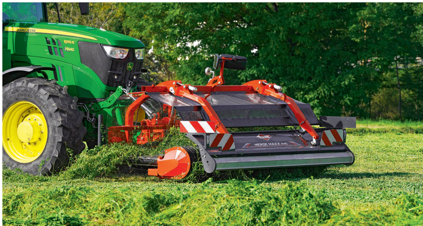
Mit dem «Merge Maxx 440F» hat Kuhn nun auch einen Bandschwader für den Frontanbau im Portfolio. Bilder: Kuhn
