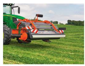
Der «Merge Maxx 440F» wird auf zwei rotierenden und in der Höhe einstellbaren Gleittellern geführt.
