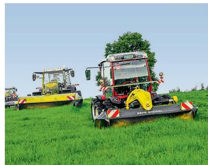
Die Firmen Sepp Knüsel und Rigitrac Traktorenbau sind Spezialisten für eine sichere Bergmechanisierung. So überzeugt der Bandrechen mit dem zehnlagigen Keilriemenband, vier grossen Tragrollen und den Doppelsteuerstangen auch bei hohen Belastungen. Das Mähwerk «Tornado» ist bekannt für Schnittqualität, Futterfluss sowie tiefes Eigengewicht und für das Klingen-Schnellwechselsystem. Der Rigitrac zeichnet sich durch seine Wendigkeit, Hangstabilität und sein Mitteldrehgelenk aus.
