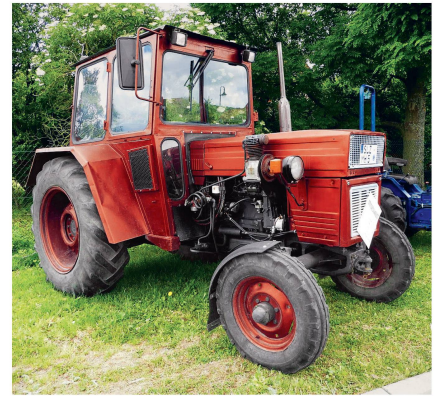
Der «UTB 550» mit Vierzylinder-UTB-Dieselmotor und Achtganggetriebe.
