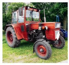
Der «UTB 550» mit Vierzylinder-UTB-Dieselmotor und Achtganggetriebe.
