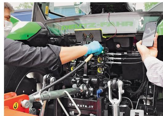
In grossen Betriebsflotten müssen viele verschiedene Traktoren mit vielen hydraulisch betätigten Anbaugeräten gekoppelt werden. Beim neuen elektronischen «Faster ABC» wird jeder Hydraulikschlauch mithilfe eines passiven «RFID»-Chips kennzeichnet. Dieser wird beim Anstecken für das System individuell erkennbar, dessen ECU automatisch über den CAN-Bus des Traktors die voreingestellte Hydraulikleistung einstellt. Ein weiterer Vorteil ist die Überwachung der korrekten Schlauchkopplung. ■
