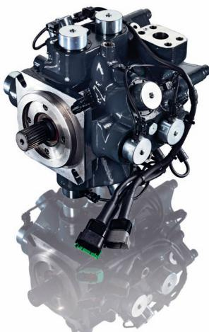
leistung bei gleichzeitig hoher Effizienz und Steuerbarkeit, indem – und das ist neu – bei jeder Wellendrehung jeder Zylinder der Radialkolbenanlage einzeln und in Echtzeit über ultraschnelle mechanische Ventile aktiviert und deaktiviert werden kann. Im Vergleich zu herkömmlichen Pumpen führt dies zu deutlich schnelleren Reaktionszeiten, einer Verlustreduktion um bis zu 10 Prozent sowie reduziertem Rauschen.
