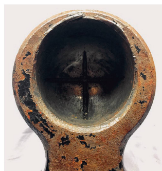
Extreme Verschleisspuren deuten auf eine fehlerhafte Niederhaltereinstellung hin.
