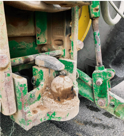
Ein üblicher Zustand eines Kugel-Systems, wie man es in der Praxis oft antrifft.
