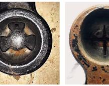
Extreme Verschleissspuren deuten auf eine fehlerhafte Niederhaltereinstellung hin.
