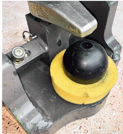
Kugel «K80» mit Schaumstoffring als Schutz vor Verschmutzung.
