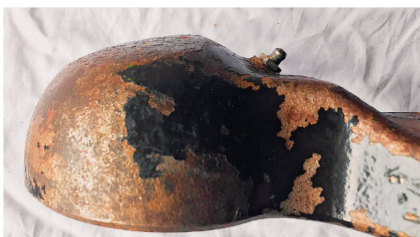
Bei diesem Beispiel war der Niederhalter falsch eingestellt.
