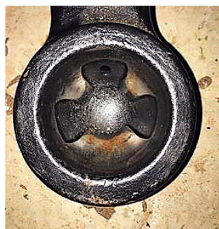
Zwei Beispiele von Kalotten mit neuer Schmiernut: Auf dem Bild links ist eine Kalotte von Walterscheid zu sehen, auf dem Bild rechts eine solche von Rockinger.
