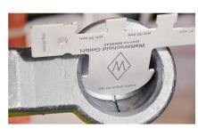
Walterscheid-Prüflehre für die Überprüfung von Kalotten.
