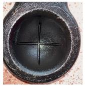
Zwei Beispiele von Kalotten mit neuer Schmiernut: Auf dem Bild links ist eine Kalotte von Walterscheid zu sehen, auf dem Bild rechts eine solche von Rockinger.
