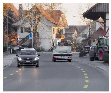
Kernfahrbahnen haben keine Mittellinie, aber auf beiden Seiten einen Fahrradstreifen: Befindet sich kein Velofahrer auf dem Fahrradstreifen, darf die unterbrochene, gelbe, Linie überfahren werden. Bild: H. Röthlisberge
