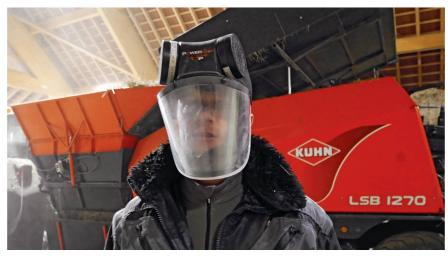
Bei extremen Staubbelastungen bieten Gebläsefiltergeräte mit Gesichtsschutz einen hohen Atemschutz. Ein Akku-Gebläse versorgt den Nutzer mit frischer Luft. Bild: H. Röthlisberger
