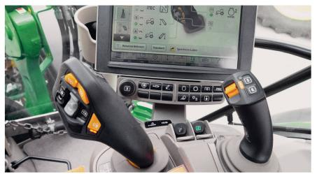
Blick auf die «Kommandozentrale»: Mit dem neugestalteten elektronischen Joystick für verschiedene Hydraulikfunktionen (rechts) kann man jetzt auch die Fahrtrichtung wechseln.
