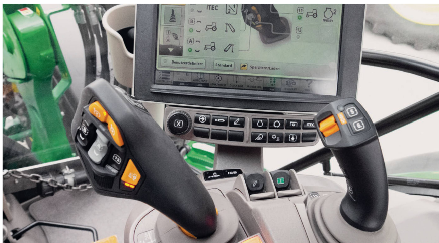
Blick auf die «Kommandozone»: Mit dem neugestalteten elektronischen Joystick für verschiedene Hydraulikfunktionen (rechts) kann man jetzt auch die Fahrtrichtung wechseln.
