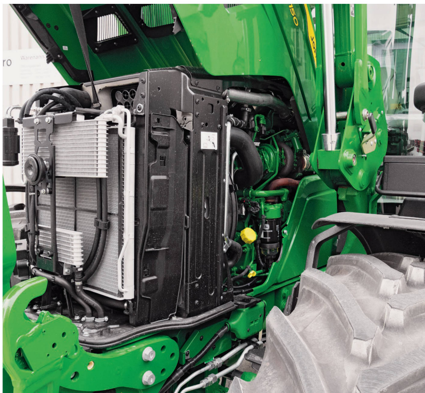
Der Motor schaltet beim «6R 150» 12 PS zusätzliche IPM-Leistung nun auch bei anspruchsvollen Hydraulikarbeiten frei.
