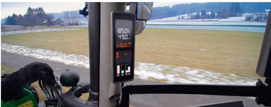
Anstelle des Armaturenbretts gibt es jetzt ein Display an der A-Kabinensäule.
