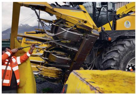
Beim Reinigen von Erntemaschinen lohnt sich vorerst eine Grobreinigung mit einem leistungsfähigen Luftkompressor. Bild: R. Hunger
