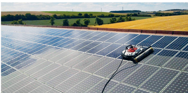
Immer mehr werden auch Reinigungsroboter eingesetzt. Sie eignen sich gut für grosse Flächen. Bild: Serbot Gekko
