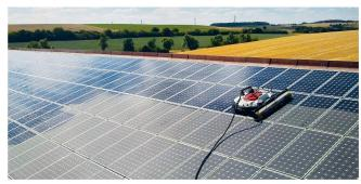
Immer mehr werden auch Reinigungsroboter eingesetzt. Sie eignen sich gut für grosse Flächen. Bild: Serbot Gekko
