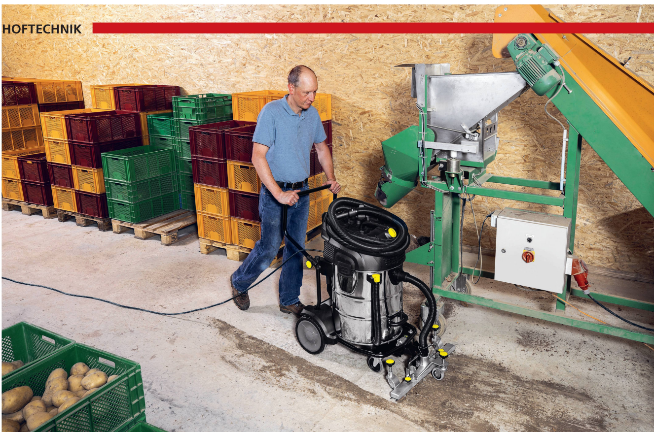
Nass-/Trockensauger für die Landwirtschaft mit 2760 Watt max. Aufnahmeleistung, 75-Liter-Edelstahlbehälter, Nass-/Trockendüse. Bild: zvg
