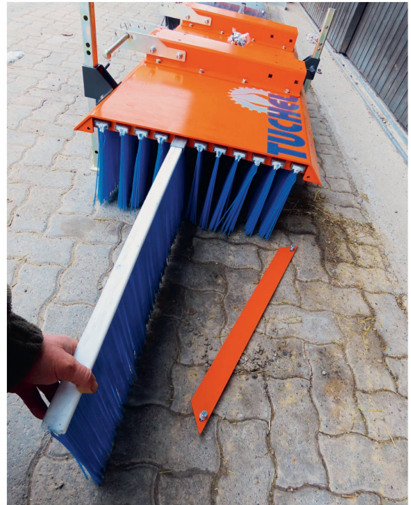
Die einzelnen Bürstensegmente lassen sich einfach herausziehen und auswechseln.
