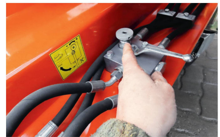
Zuschaltung des Seitenbesens und Anpassung der Drehzahl.
