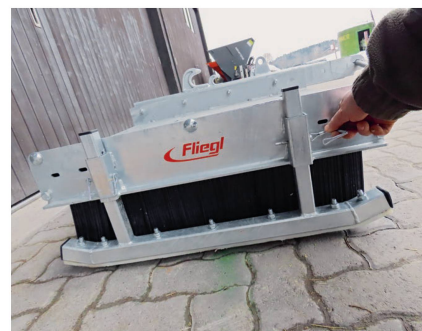
Über die verstellbaren Einstellhilfen begrenzt man den Druck auf den Besen.
