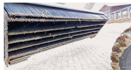
Blick auf die Unterseite mit harten Borsten und Randbürsten.
