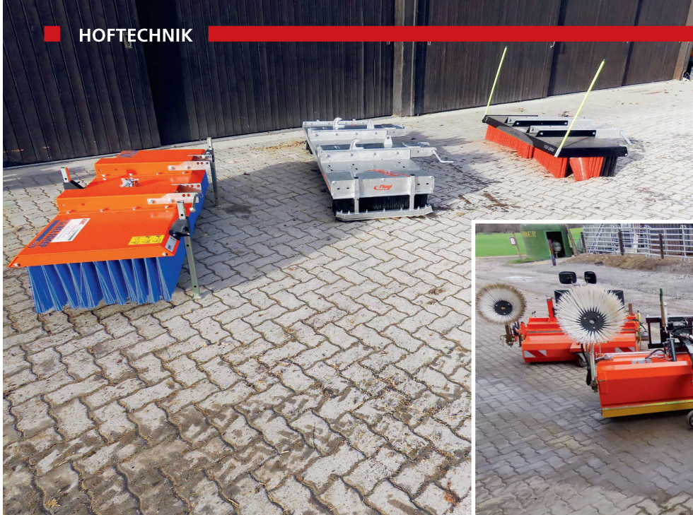
Die sechs Wischmaschinen im Test: Links die Schiebebesen, rechts die Kehrbürsten mit hydraulischem Antrieb. Bilder: M. Abderhalden
