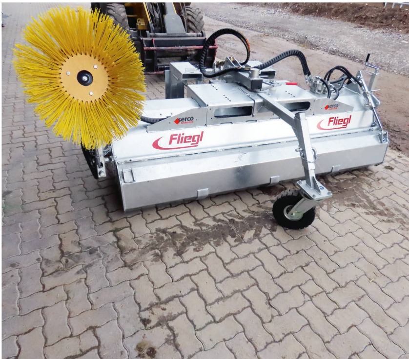
Fliegl «Typ 600» ist mit massiven Stützrädern ausgerüstet.
