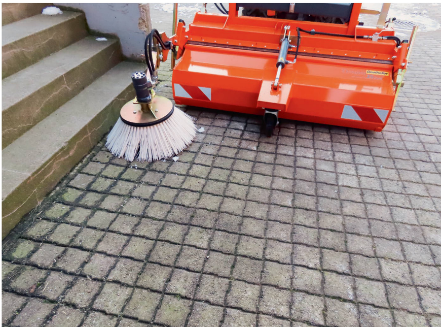
Mit dem Seitenbesen lassen sich auch enge Stellen zukehren.
