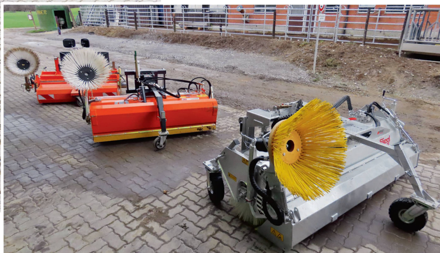
Die sechs Wischmaschinen im Test: Links die Schiebebesen, rechts die Kehrbürsten mit hydraulischem Antrieb. Bilder: M. Abderhalden
