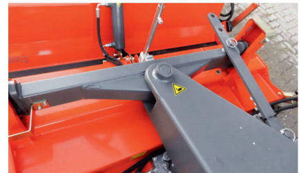
Der 3D-Rollenausgleich ermöglicht eine Bodenanpassung auf alle Seiten.
