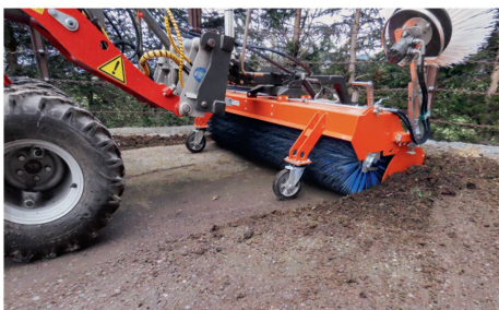
Nahe angebrachte Stützräder sorgen für eine saubere Aufnahme.
