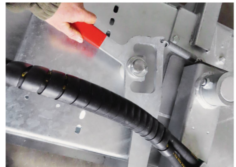
Über eine einfache Rasterung lässt sich die Maschinen um je 30° schwenken.
