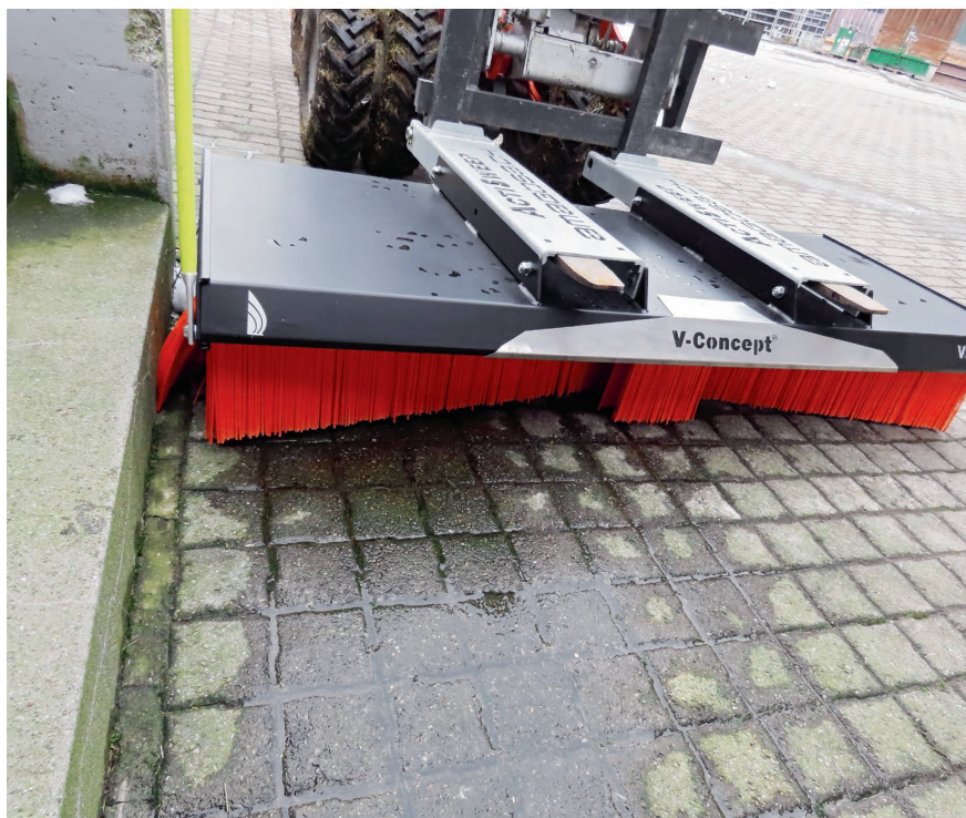
Mit den V-förmigen Bürsten vorne wird das Material vor der Maschine gehalten.
