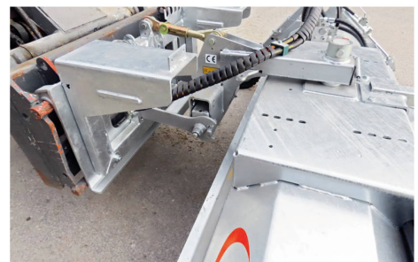
Dank Parallelogramm mit Teleskopoberlenker ist die Bodenanpassung ideal.
