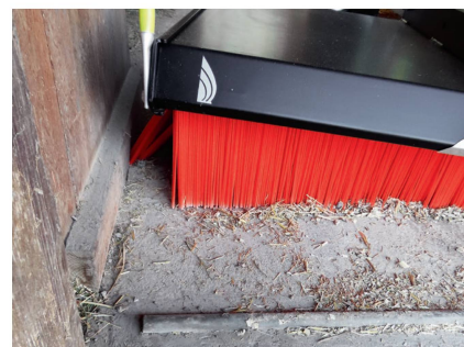
Die seitlichen Auffangbürsten erlauben auch ein sauberes Kehren einer Wand entlang.
