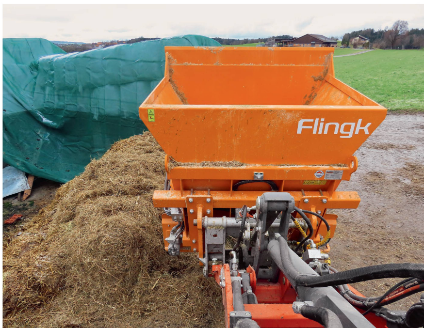
Dank dem eng taillierten Behälter ist die Sicht nach vorne aus dem Hoflader ausreichend.
