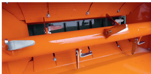
Das Rührwerk mit insgesamt sieben Doppelfingern ist reversierbar.
