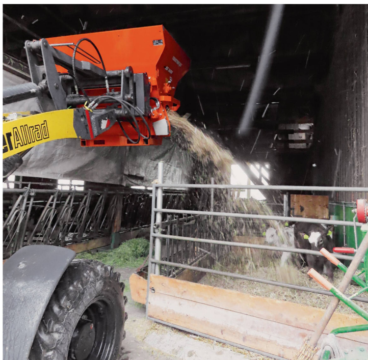
Auch 20 cm langes Stroh lässt sich direkt ab Balle mit ordentlicher Reichweite verteilen.
