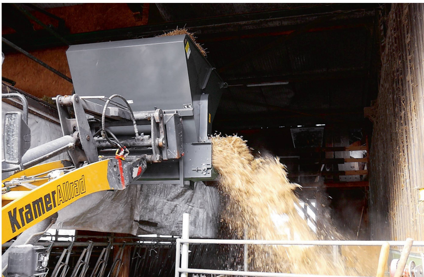
Mit 1,85 m³ war diese Schaufel die grösste im Test.
