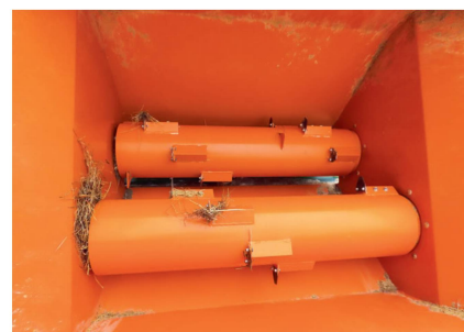
Die beiden einzeln angetriebenen Dosierwalzen sind mit 22 Messern bestückt.
