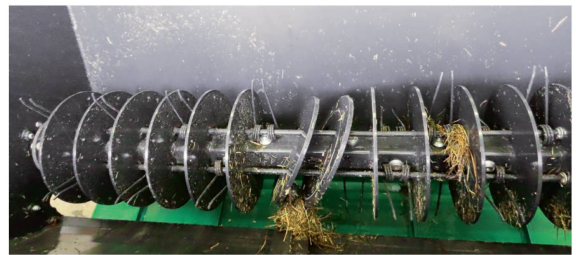
Die Walze ist mit gesicherten Federzinken bestückt.
