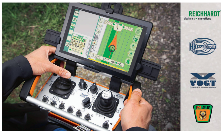
Intelligente Fernbedienungen zur Unterstützung von teilautomatisierten Arbeitsprozessen.
