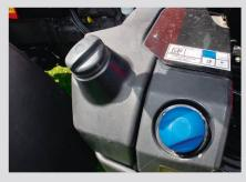
AdBlue pro Jahr. Der AdBlue-Tank wird in der Regel elektronisch überwacht. Ist der AdBlue-Tank leer, kann man den Motor nicht mehr starten.
