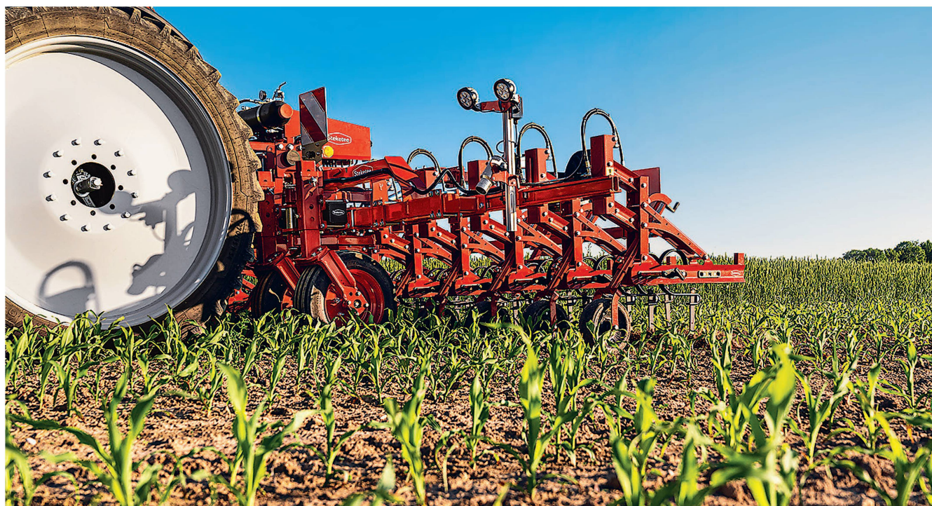
Auch Hackgeräte verfügen heute über allerlei Sensoren, was zu einer genaueren und effizienteren Arbeit führt. Bild: Lemken/Steketee
