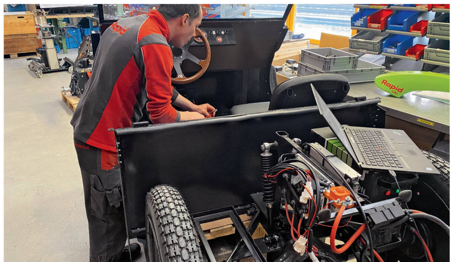
Die Antriebseinheit eines Rapid «Uri» mit dem Wechselakku (unter dem Laptop) auf dem Fahrgestell. Bild: Rapid
