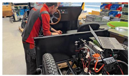
Die Antriebseinheit eines Rapid «Uri» mit dem Wechselakku (unter dem Laptop) auf dem Fahrqestell, Bild: Rapid
