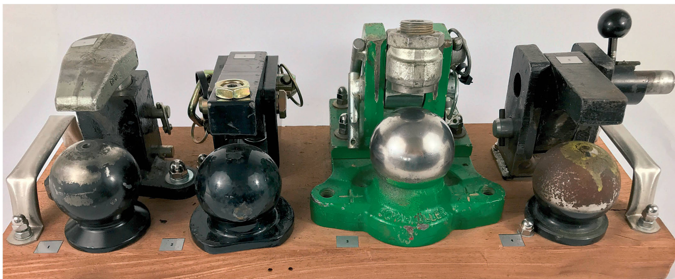
Diverse Verriegelungssysteme des Kugel-80-Systems unterschiedlicher Hersteller. Bilder: Walterscheid
