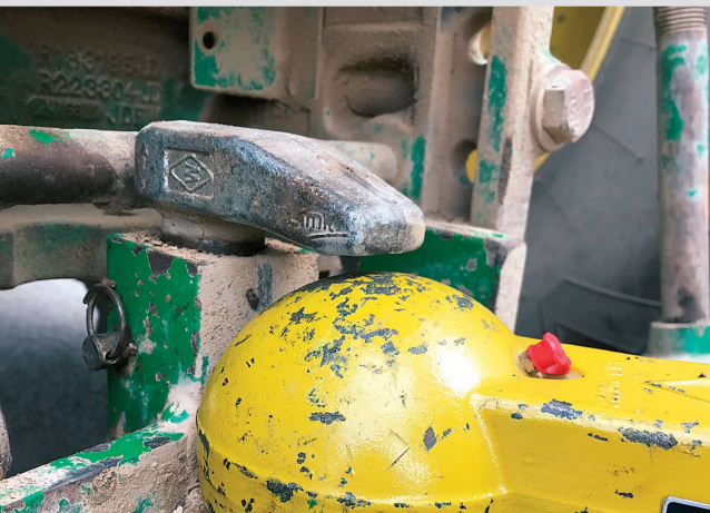
Falsche Einstellung des Niederhalters – Das «Spiel» zwischen Niederhalter und Kalotte ist viel zu gross.
