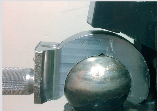
Die Walterscheid Prüfkalotte ermöglicht eine einfache Überprüfung der Niederhaltereinrichtung.
