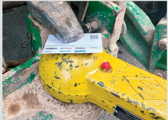
Richtige Einstellung des Niederhalters – 0,5 mm entspricht der Stärke einer Visitenkarte.
