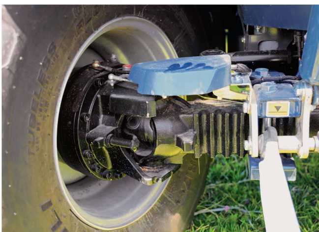
Die vier nassen Scheibenbremsen sind wartungsfrei.
