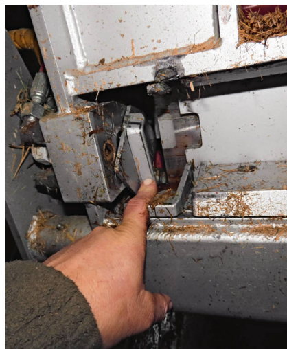
Diese automatische Abdeckung schützt die Anschlüsse vor grober Verschmutzung.
