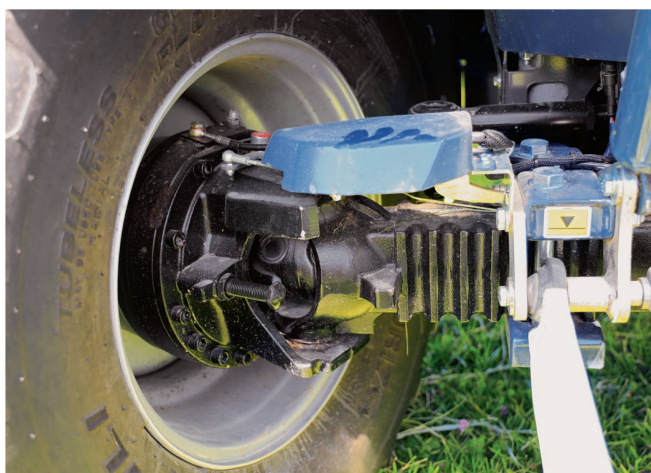
Die vier nassen Scheibenbremsen sind wartungsfrei.
