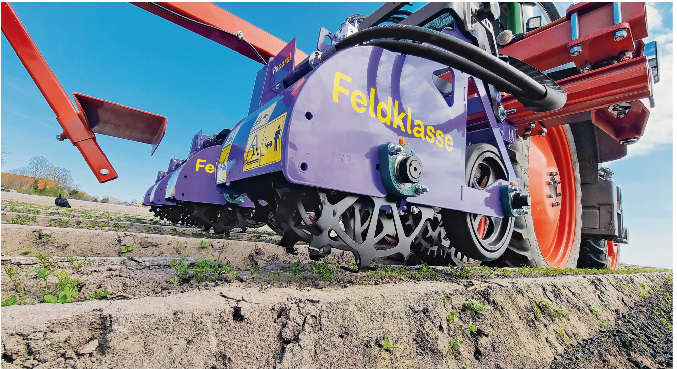
Hackeinheit des «Feldklasse»-Hackgeräts. Zu sehen sind hier die Zackscheiben (vorne in Fahrtrichtung) mit Tiefenführungsrad und die nachfolgende Rotationsschar. Bild: Feldklasse
