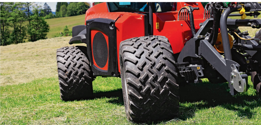
Grosse Räder (sie verringern Bodendruck) und vier Lenkungsarten: 2-Rad-, 4-Rad-, Hundegang oder manuelle Lenkung. Die Driftlenkung ist optional.
