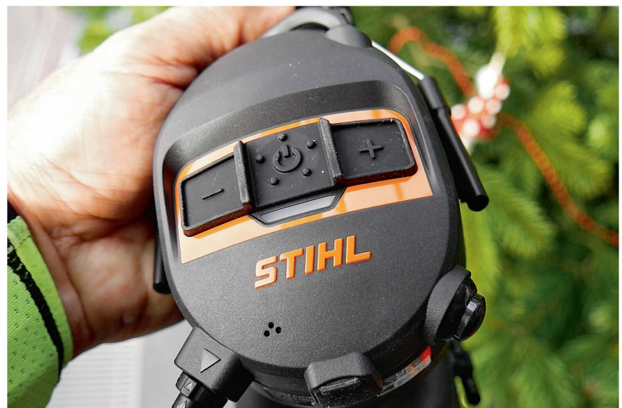
«Advance Procom» besitzt insgesamt sechs Bedienelemente, die zum Teil noch mehrfach belegt sind. Trotzdem stellt sich bei der Handhabung schnell eine gewisse Routine ein.
