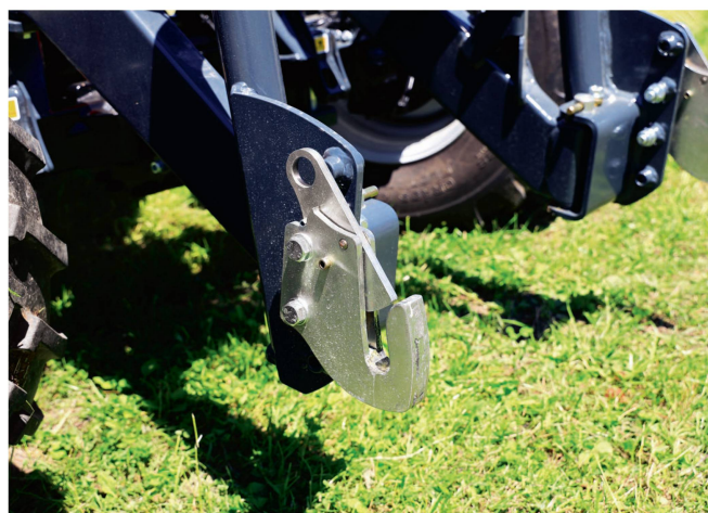
Die Unterlenkerhaken lassen sich von Kat. 1 auf Kat. 2 umschrauben.
