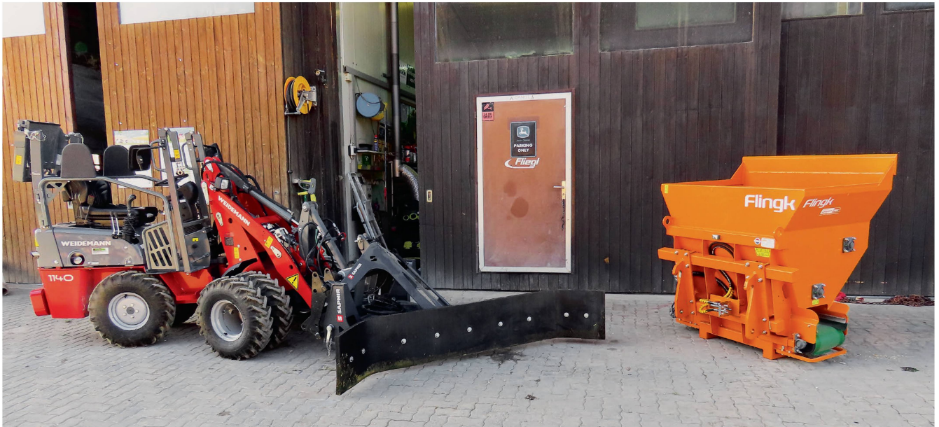
Der Schnellwechsler wurde im Test an einem Euroadapter für diverse Anbaugeräte wie Mistschieber, Einstreuschaufel oder Ballenzange eingesetzt. Bilder: M. Abderhalden
