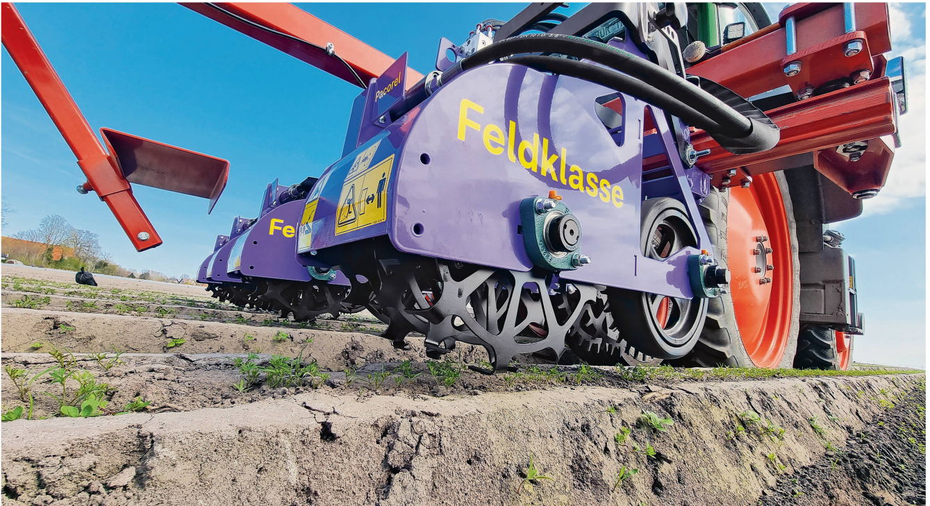
Hackeinheit des «Feldklasse»-Hackgeräts. Zu sehen sind hier die Zackenscheiben (vorne in Fahrtrichtung) mit Tiefenführungsrad und die nachfolgende Rotationsschar. Bild: Feldklasse
