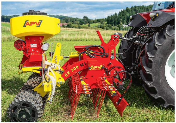
Kurz gebaute Striegel-Sägerät-Kombination mit zwei Zinkenreihen. Bild: APV
