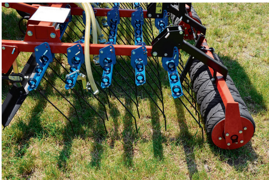
Die Kombination von Striegelzinken, Übersaattechnik und Walzelement sichert dem Saatgut den Bodenkontakt. Bild: R. Hunger
