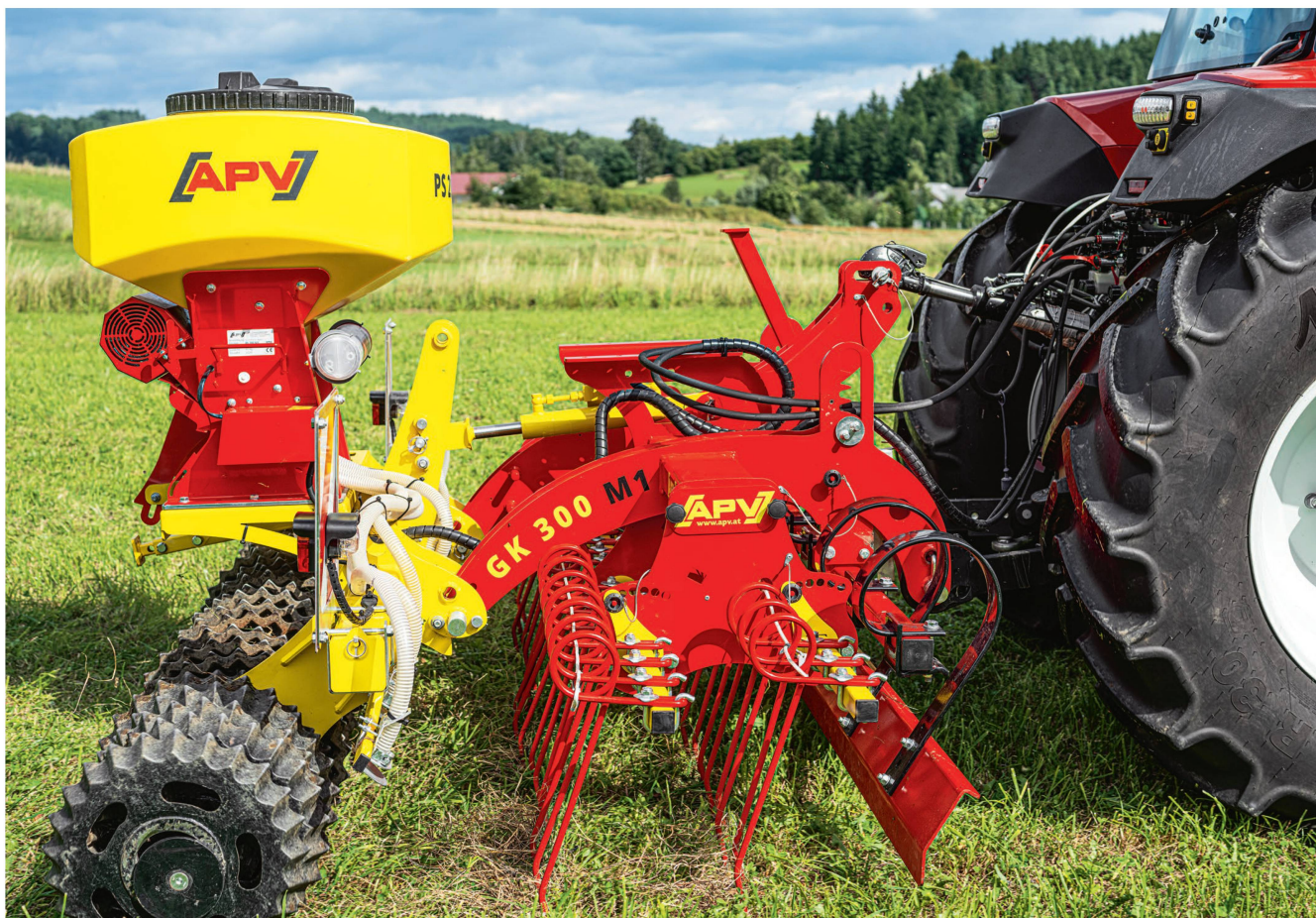
Kurz gebaute Striegel-Sägerat-Kombination mit zwei Zinkenreihen. Bild: APV
