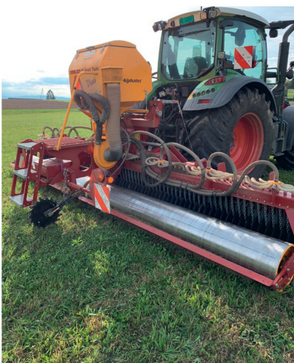
Für die Übersaaten bei Rüedis kommt eine Vredo-6-Meter-Direktsaatmaschine mit Glattwalze zum Einsatz. Bild: zvg
