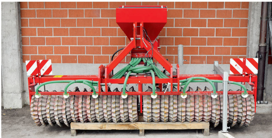
Walzen können wie jedes Pflegegerät mit einem pneumatischen Sägerät ausgestattet werden. Bild: R. Hunger
