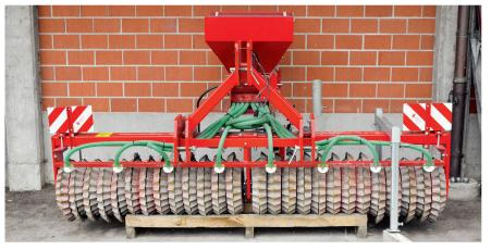
Walzen können wie jedes Pflegegerät mit einem pneumatischen Sägerät ausgestattet werden. Bild: R. Hunger
