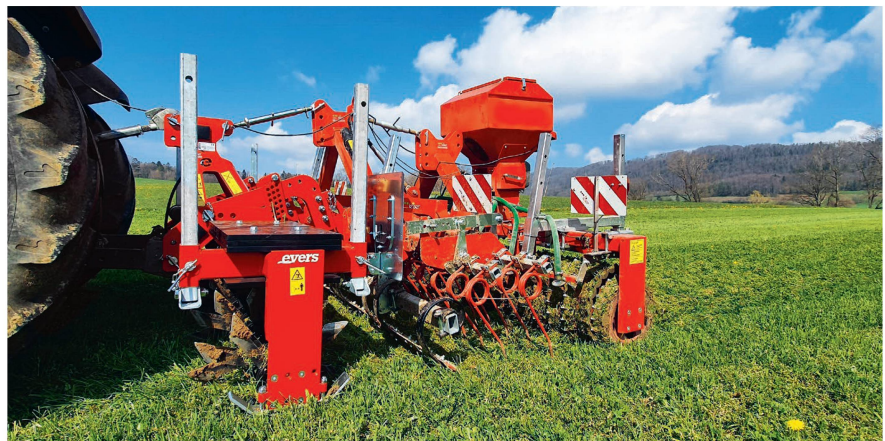
Grasnarbenbelüfter beseitigen Verfestigungen in der oberen Bodenstruktur. Bild: Evers
