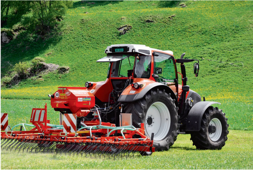
Die Striegelzinken sind auf verschiedene Felder aufgeteilt, damit ist eine gute Bodenangepassung möglich. Bild: R. Hunger
