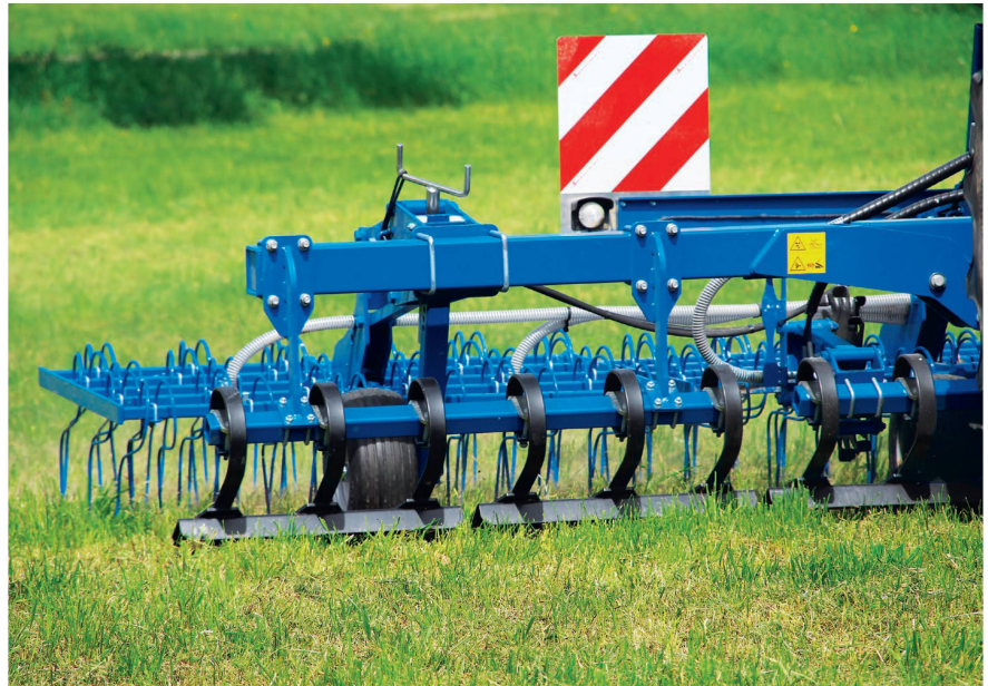
Vor den Striegelzinken ist ein gefedertes Erdleitblech, aufgeteilt in mehrere Segmente, montiert. Bild: Köckerling
