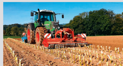
Das «Mulch-Hobelsaat-System Villiger», wie es gegen den Maiszünsler eingesetzt wird.
