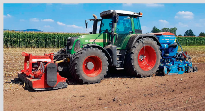
Das «Mulch-Hobelsaat-System Villiger», wie es gegen den Maiszünsler eingesetzt wird.
