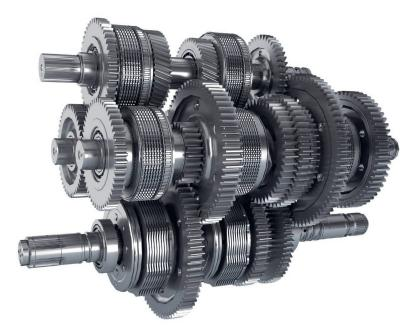
Bild 6: Das Volllastschaltgetriebe «e23» von John Deere weist 23 Vorwärts- und 11 Rückwärtsgänge mit Stufensprüngen im Bereich von 1,15 auf. Bild: John Deere
