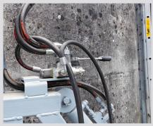
Die Steuerung der Seitenarme erfolgt hydraulisch über ein Steuerventil.
