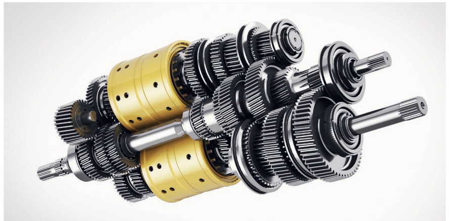
Bild 3.1: 8-fach-Lastschaltgetriebe mit Doppelkupplungstechnik von CNH: Mit nur zwei Lamellenkupplungen lassen sich acht Lastschaltstufen schalten. Bild: New Holland
