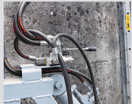
Die Steuerung der Seitenarme erfolgt hydraulisch über ein Steuerventil.
