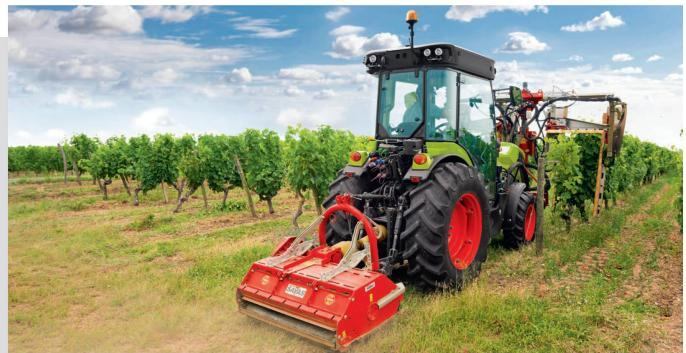
1,45 m Breite die Modellreihen «S», «M» und «L» mit identischen Außenbreiten. Ergänzt wird das Portfolio fortan um die neue Variante «Nexos XL» mit 1,55 m Außenbreite und die 1,25 m oder 1,45 m schmalen sowie flachen Plattform-Baureihen «Nexos MD» und «Nexos LD» für Obstplantagen.
