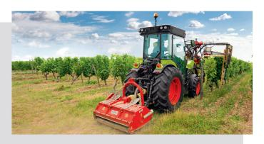
1,45 m Breite die Modellreihen «S», «M» und «L» mit identischen Aussenbreiten. Ergänzt wird das Portfolio fortan um die neue Variante «Nexos XL» mit 1,55 m Aussenbreite und die 1,25 m oder 1,45 m schmalen sowie flachen Plattform-Baureihen «Nexos MD» und «Nexos LD» für Obstplantagen.
