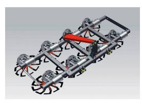
Das Gerätesystem des «Grinder» besteht aus neuartigen multifunktionalen Werkzeugen, die gleichzeitig schneiden und zerkleinern können. Ziel ist, eine Arbeitstiefe von 2 cm über die gesamte Breite einzuhalten.
